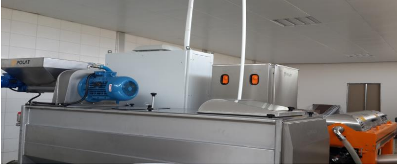
Şekil 3.3. Ekstraksiyonun gerçekleştiği kırıcı ve malaksör ünitesi
