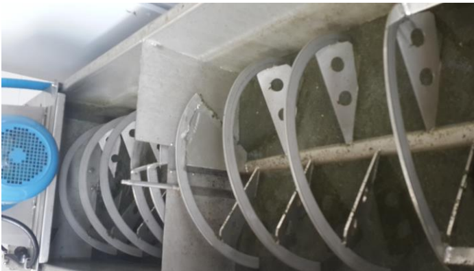
Şekil 3.4. Malaksörde stevia ekstraksiyonunun gerçekleştirilmesi
