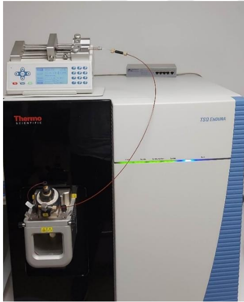
Şekil 3.6 ESI ünitesi, akışı kontrol eden otomatik pompa ve bileşiğin aktığı PEEK hortum.
