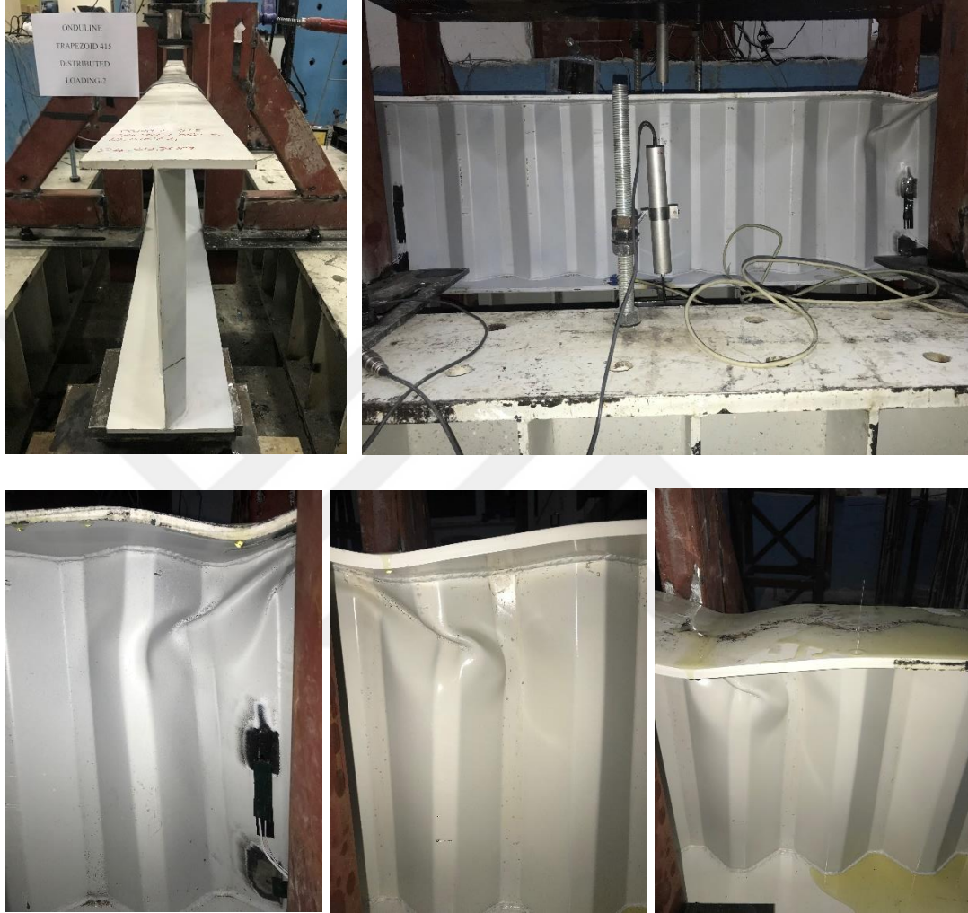
Şekil 4.34. TGOK_415 Test_2; yayılı yükleme altında göçme durumları
