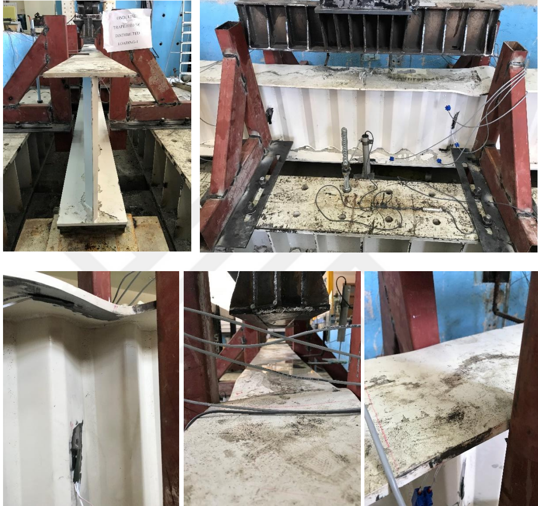
Şekil 4.28. TGOK_500 Test_1; yayılı yükleme altında göçme durumları
