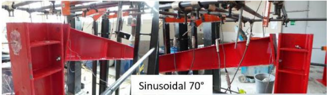
Şekil 2.12. Sinüzoidal gövdeli kirişin deney sonrası göçme durumu ve bulonları
