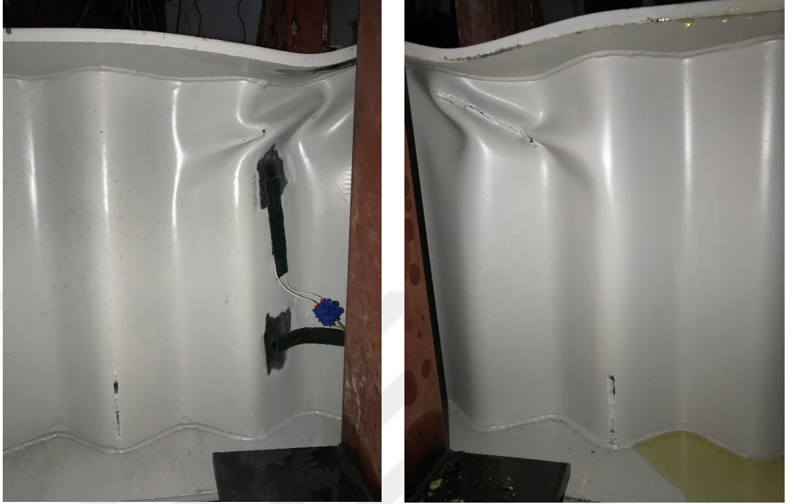
Şekil 2.35. Gövdede burkulma (SGOK_415 Yayılı Yükleme Deney Fotoğrafı 2019)
