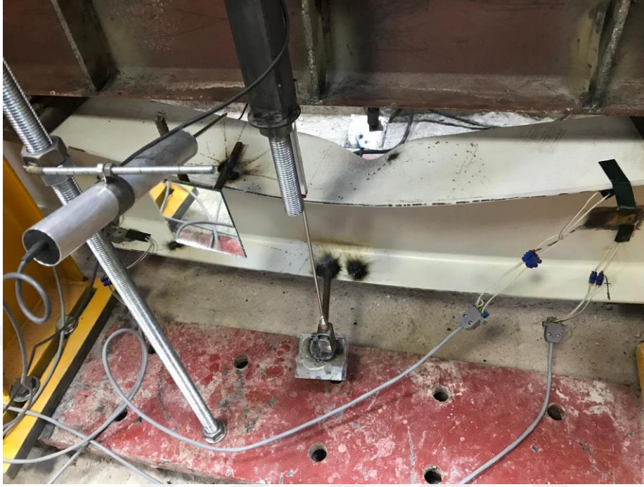
Şekil 4.54. IPE 300 deney elemanının deformasyon sonucu
