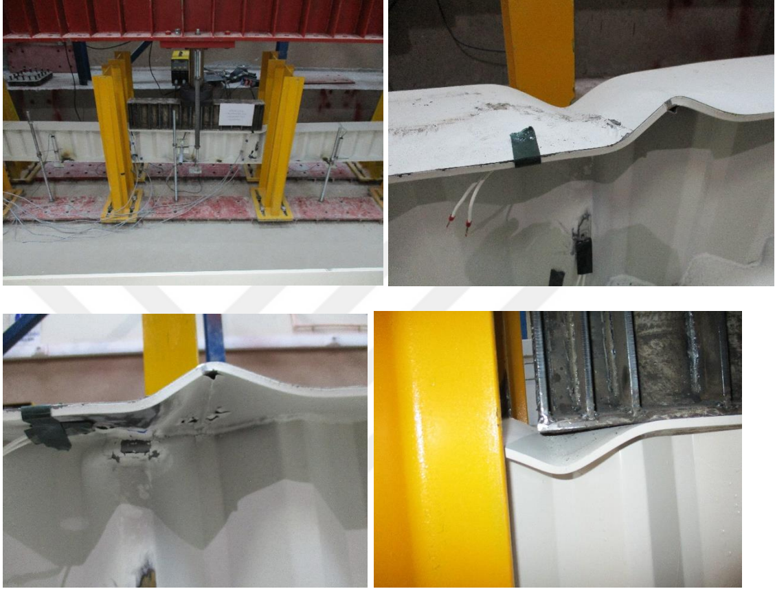
Şekil 4.36. TGOK_330 Test_1; yayılı yükleme altında göçme durumları
