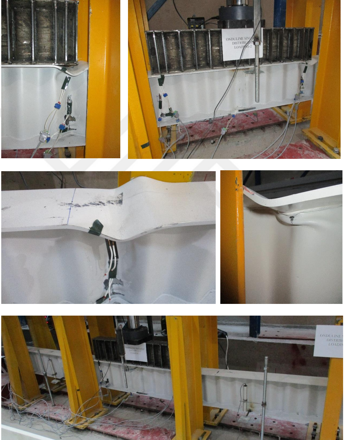
Şekil 4.12. SGOK_330 Test_2; yayılı yükleme altında göçme durumları
