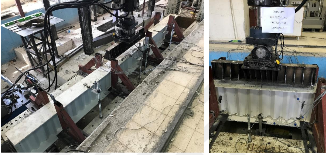
Şekil 4.27. Trapezoidal gövdeli ondülin kiriş testi; yayılı yükleme durumu
