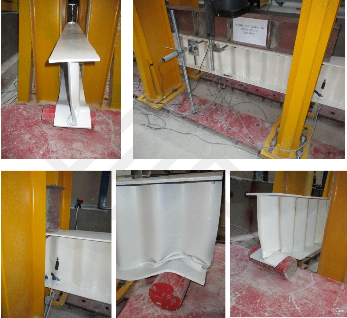
Şekil 4.10. SGOK_330 Test_1; yayılı yükleme altında göçme durumları
