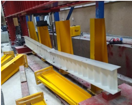
Şekil 2.36. Basit eğilme (SGOK_330 İki Noktalı Yükleme Deney Fotoğrafı 2019)
