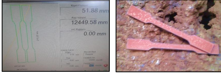
Şekil 3.25. Ondülin gövdeli kirişlerden alınan numune örnekleri
