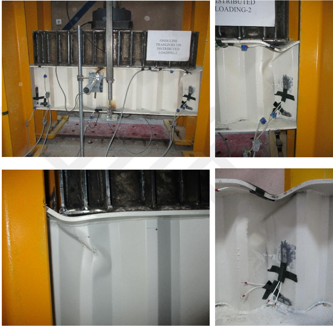
Şekil 4.38. TGOK_330 Test_2; yayılı yükleme altında göçme durumları
