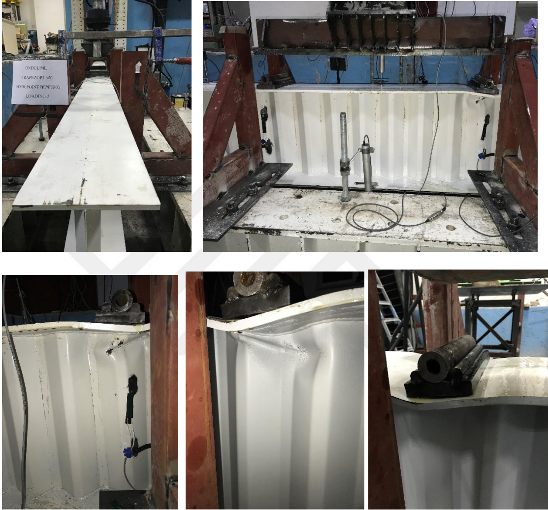
Şekil 4.43. TGOK_500 Test_2; iki noktalı yükleme altında göçme durumları
