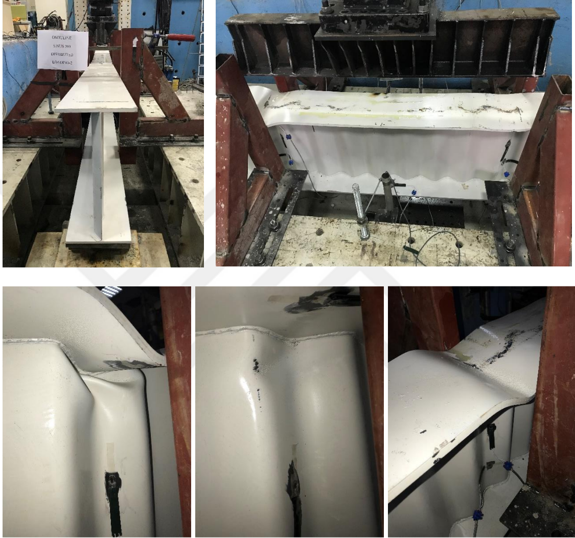
Şekil 4.4. SGOK_500 Test_2; yayılı yükleme altında göçme durumları
