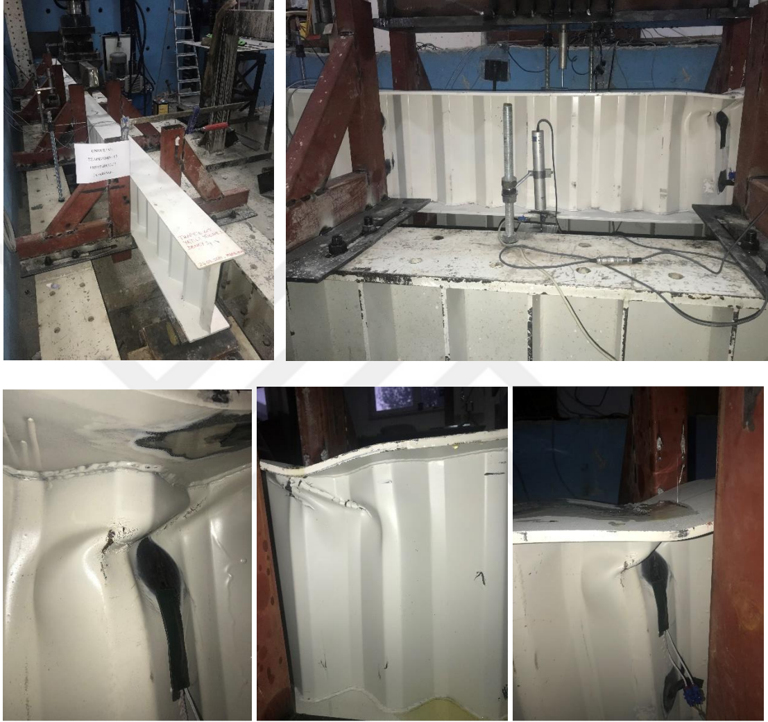
Şekil 4.32. TGOK_415 Test_1; yayılı yükleme altında göçme durumları
