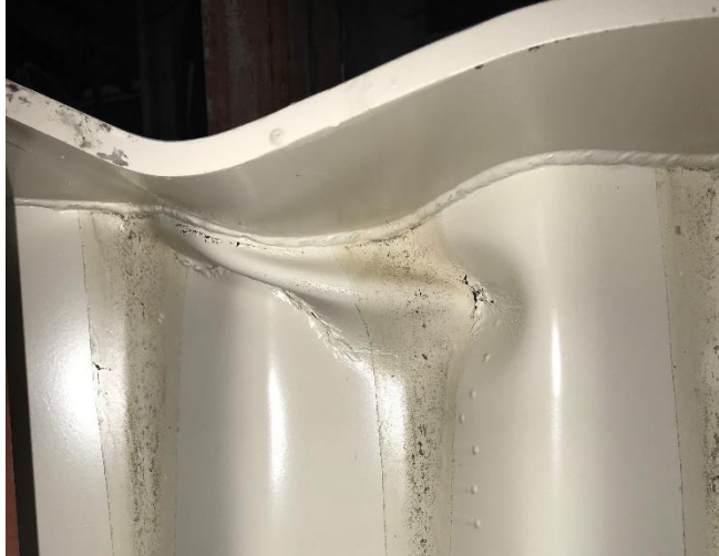
Şekil 4.65. SGOK_500 Yayılı yükleme altında gövde ve başlıkta deneysel deformasyon sonucu
