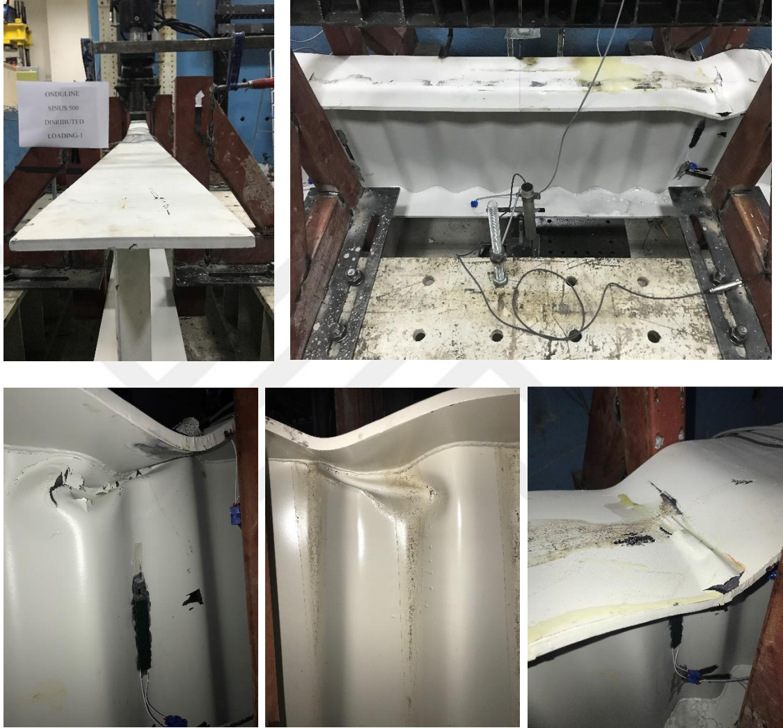
Şekil 4.2. SGOK_500 Test_1; yayılı yükleme altında göçme durumları
