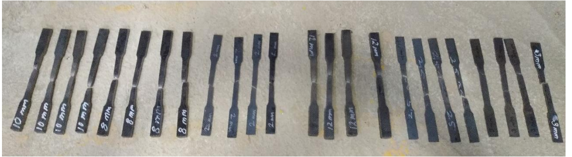
Şekil 3.27. Çekme testi uygulanmış kuponlar numuneleri
