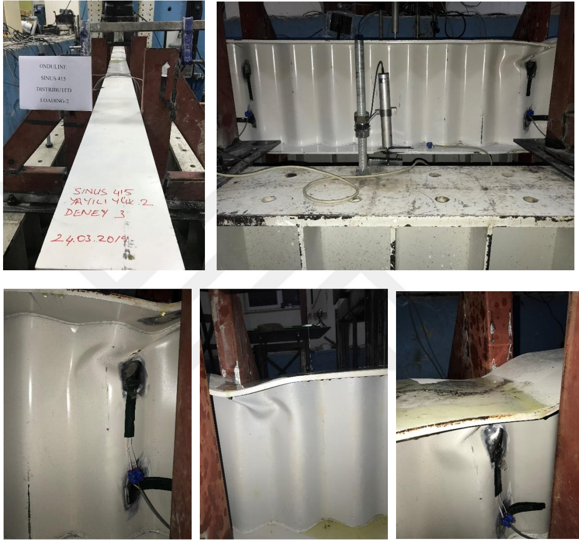
Şekil 4.8. SGOK_415 Test_2; yayılı yükleme altında göçme durumları
