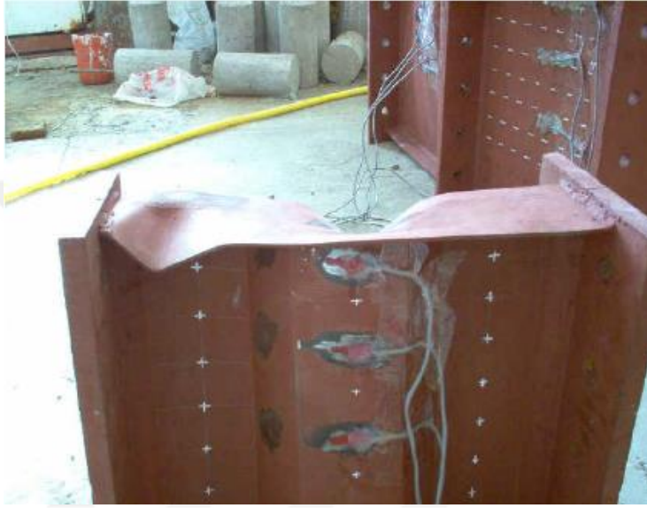
Şekil 2.25. Deformasyona uğramış kiriş test numunesi
