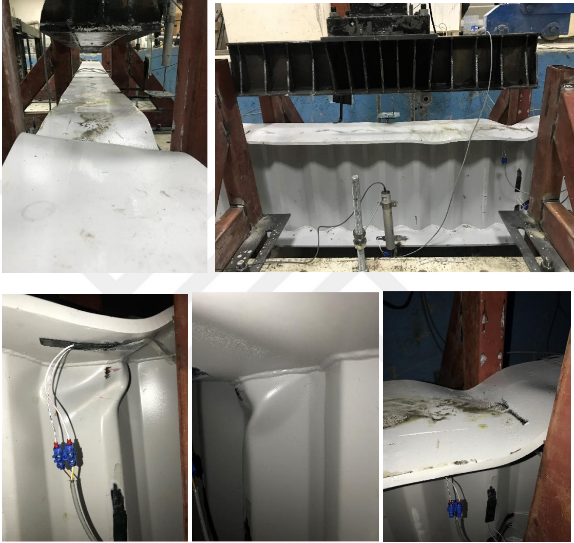
Şekil 4.30. TGOK_500 Test_2; yayılı yükleme altında göçme durumları
