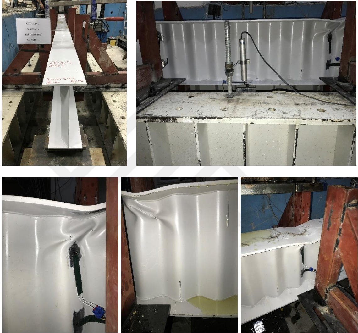
Şekil 4.6. SGOK_415 Test_1; yayılı yükleme altında göçme durumları
