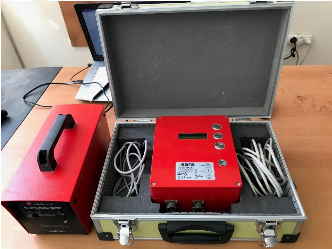
Şekil 3. 27 Sara Acebox SA10 marka ve modeli 3 eksenli ultra hassas sismik ivmeölçer
