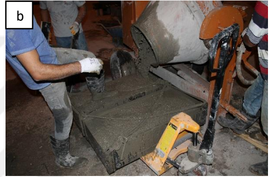
Şekil 3.12 Kat betonlarının hazırlanması a) 0,25 m 3 kapasiteli betonyer b) Hazırlanan betonun hem istenilen işçilik kusurlarının oluşması hem de laboratuvar imkanları doğrultusunda elle dökülmesi
