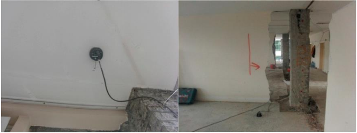
Şekil 2.4 Döşemenin kolon çevresindeki bölgelere yerleştirilen sensörler(Soyoz vd. 2013)
