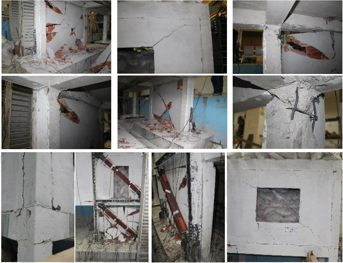
Şekil 4.78 %2 göreli kat ötelemesinde gözlenen hasarlar
