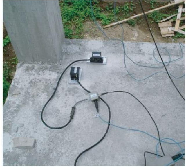
Şekil 2.7 İvmeölçerlerin test edilen binadaki yerleşimleri (Sarno vd. 2011)
