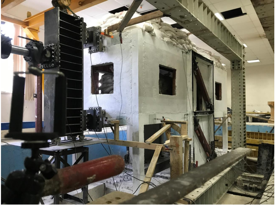
Şekil 3.1 Hidrolik piston yardımıyla yükleme yapılmaya hazır BEÇÇ'ler ile güçlendirilmiş kusurlu binanın genel görünümü
