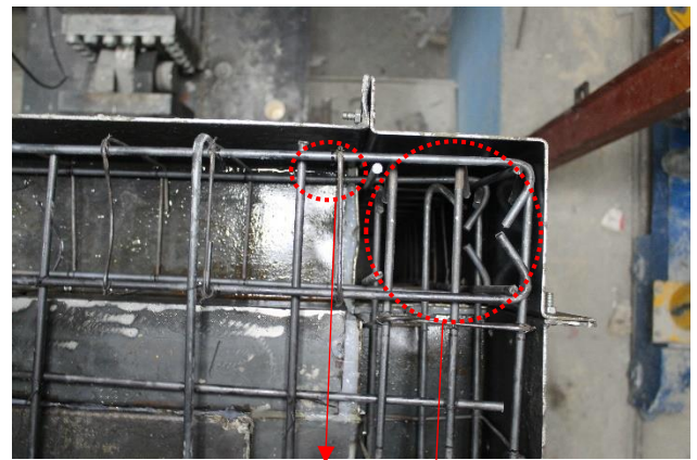
Şekil 3.6a ve Şekil 3.6b Yetersiz sayı ve nitelikteki etriyeler
