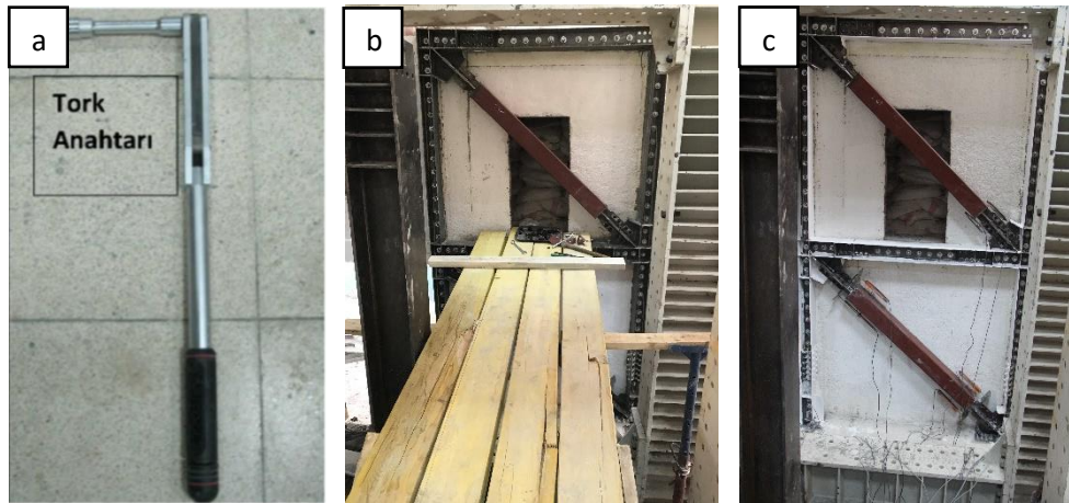
Şekil 3.23 BEÇÇ elemanların montajının yapılacağı bayrak levhaları
