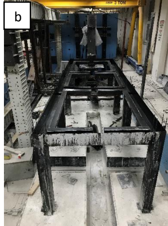
Şekil 3.13 Kalıp kurulum aşamaları a) Kolon kalıpları b) Kiriş kalıpları c) Döşeme kalıpları ve kalıp kurulumunun tamamlanması
