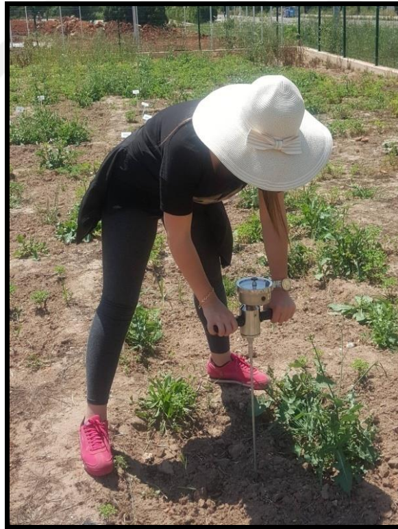
Şekil 3.14. Toprakların penetrometre direncinin belirlenmesi.
