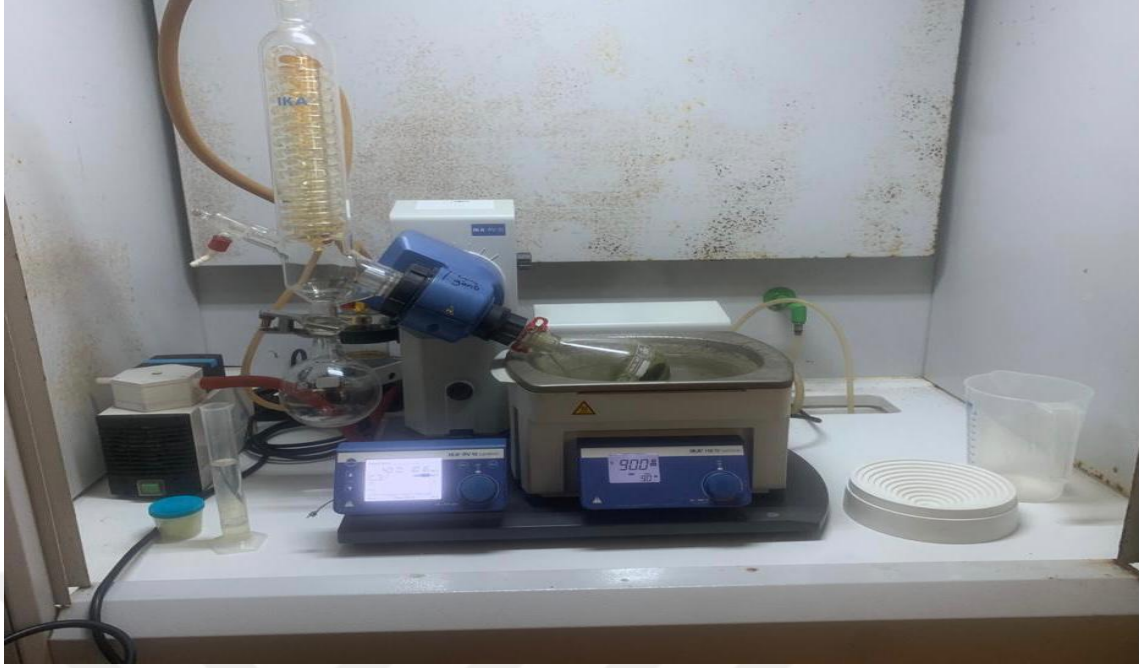
Şekil 3.6. Etil alkollü ekstraktlarda ki alkolün evaporatör ile uzaklaştırılması
