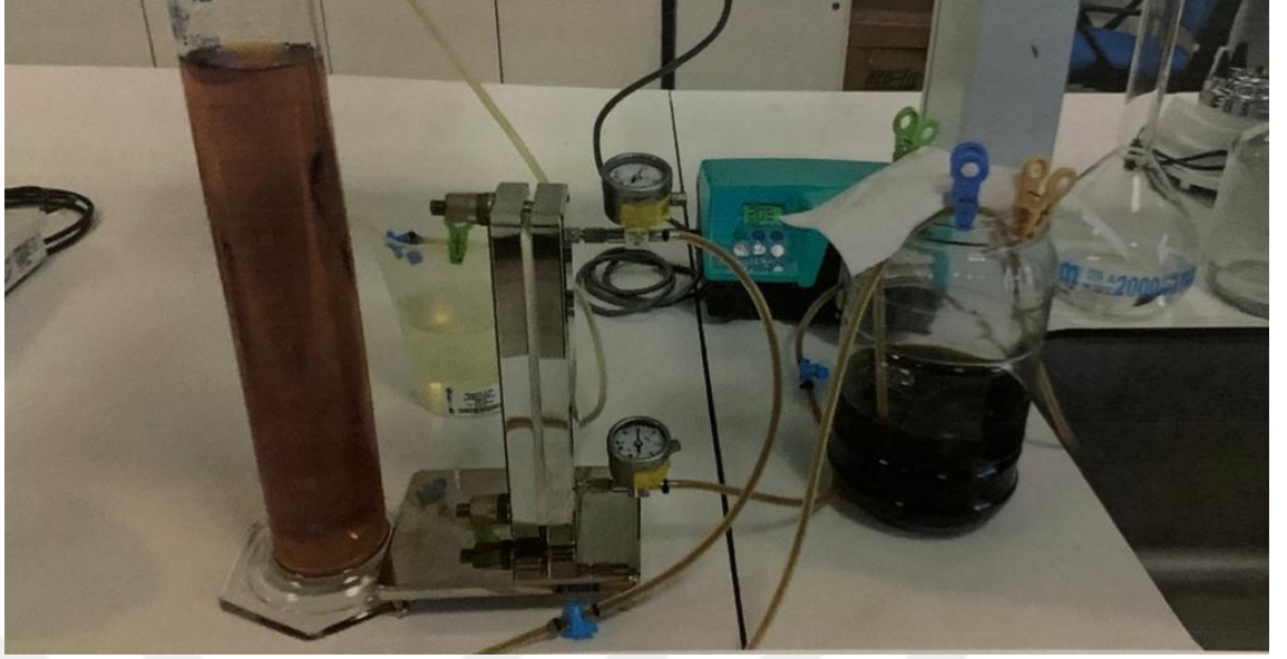
Şekil 3.4. Ekstraktların 30 kDa ayırma sınırına sahip membran ile mikrofiltrasyonu
