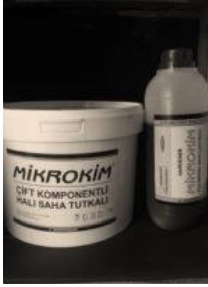
Şekil 3.3. Kullanılan poliüretan tutkal ve sertleştirici komponenti
