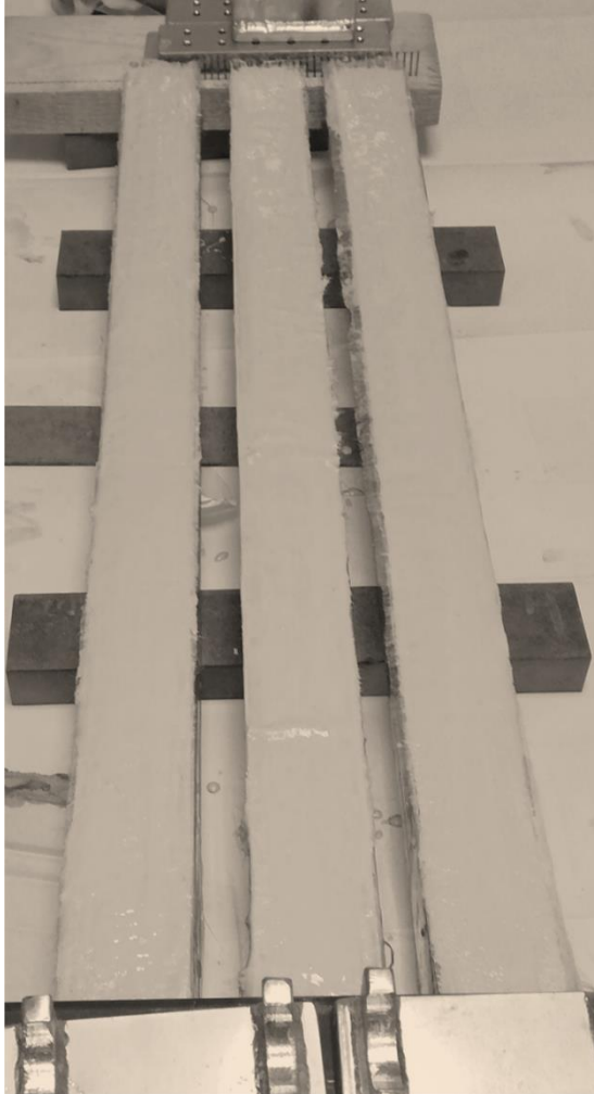
Şekil 3.7. Numune üzerine poliüretan sürülmesi
