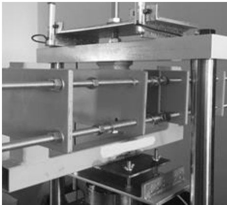
Şekil 3.2. Modifiye edilmiş 3 ray kayma testi düzeneği (Sargın 2018)
