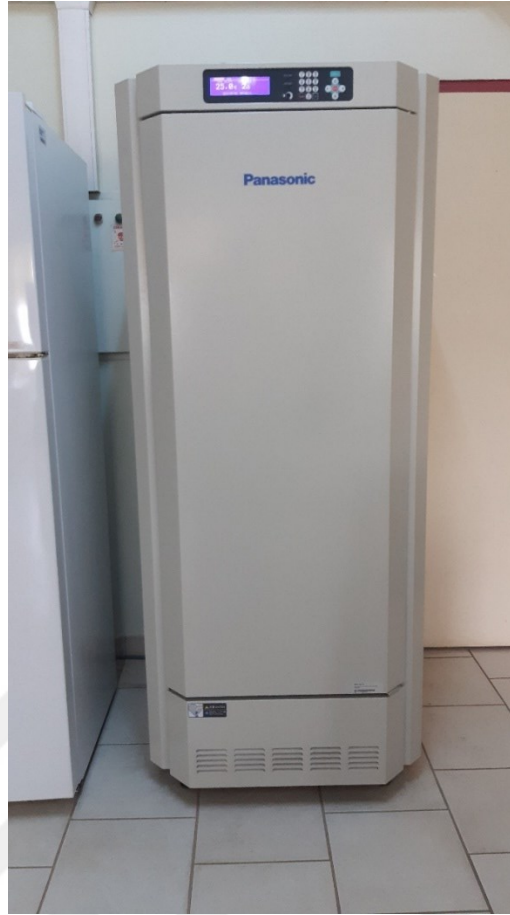
Şekil 3.7. Kültüre alınan anterlerin inkübasyonunda kullanılan iklimlendirme kabini
