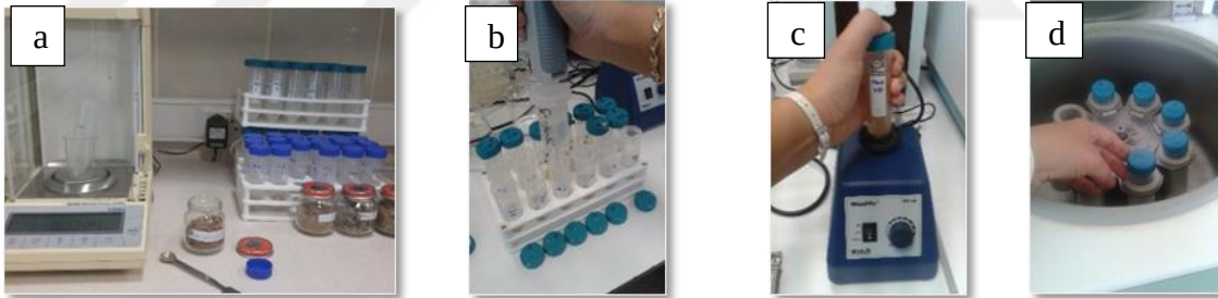
Şekil 3.23. Ekstraksiyon aşamaları; a) tartım işlemi; b) çözgenin eklenmesi; c) vorteks işlemi; d) santrifüj işlemi
