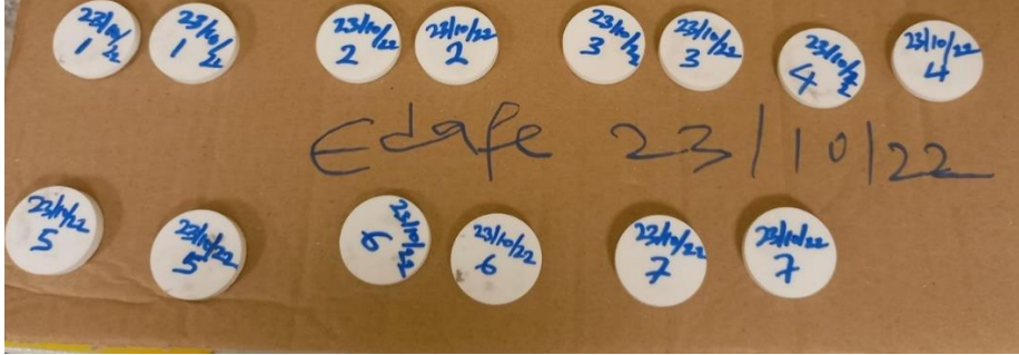
Şekil 3.14. Yedi örnekleme istasyonu için XRF analizine hazırlanan peletlerin görüntüleri (Orijinal)
