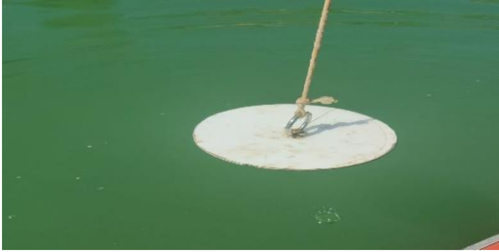
Şekil 3.10. Secchi diski ile ışık geçirgenliği ölçümü (Orijinal)
