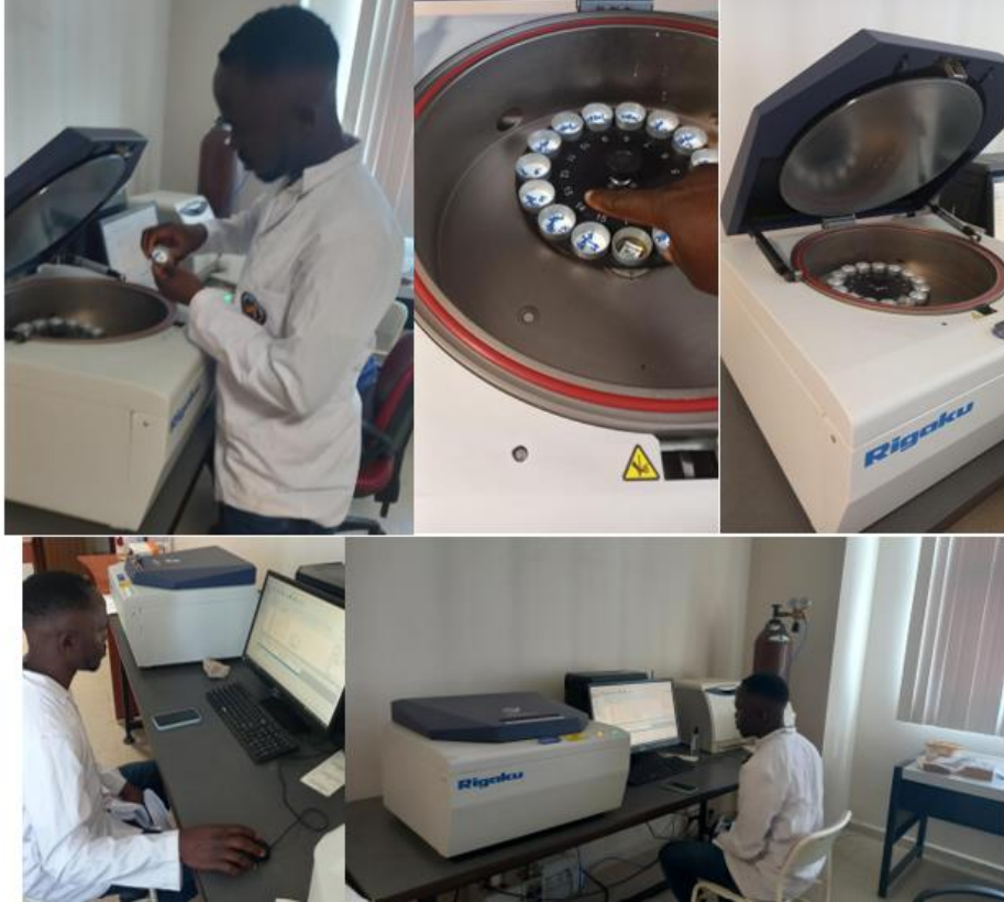
Şekil 3.15. Numunelerin ağır metal içeriğini analiz etmek için kullanılan Rigaku XRF makinesinin görüntüleri (Orijinal)
