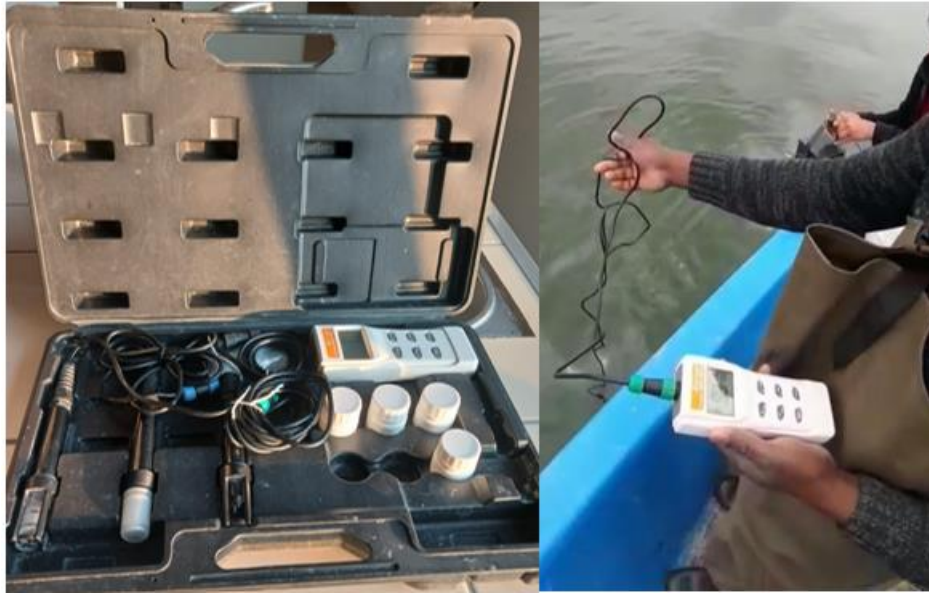
Şekil 3.9. AZ COMBO çok parametrelili ölçüm cihazı (Orijinal)
