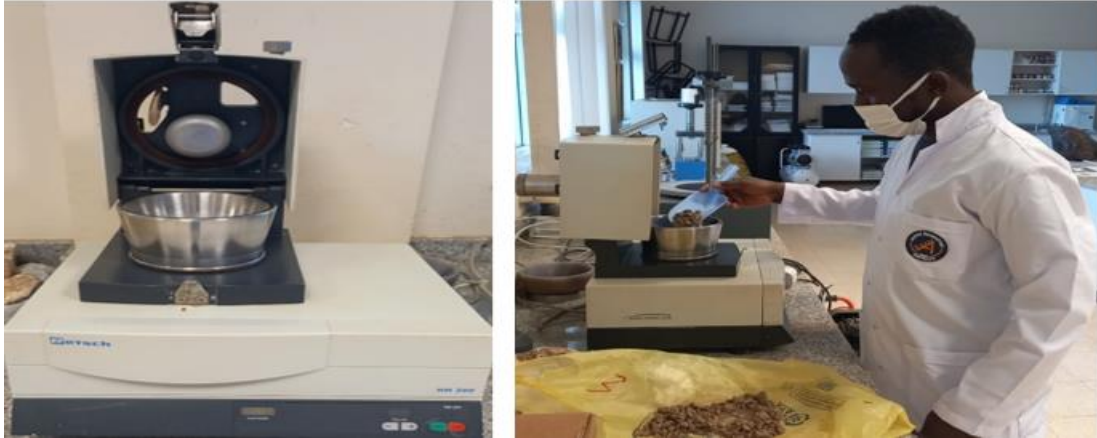
Şekil 3.13. Retsch RS200 titreşimli diskli öğütücü, öğütmeye hazırlık olarak numunelerin titreşimli diskli öğütücü konulmasının görüntüleri (Orijinal)
