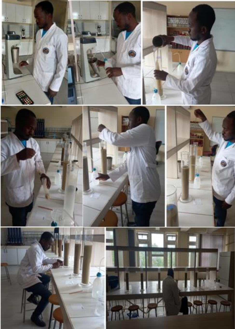
Şekil 3.17. Bouyoucos-hidrometre yöntemi ile sediment tekstürü analiz görüntülenmesi (Orijinal)
