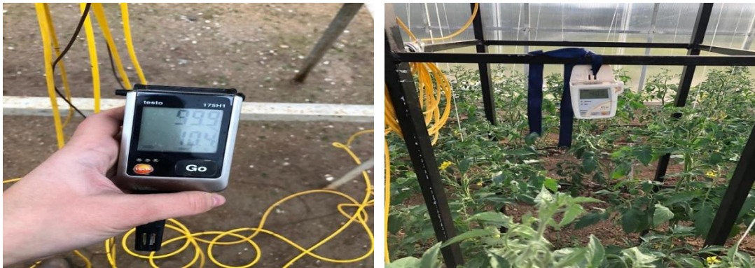
Şekil 3.5. Sıcaklık ve bağıl nem veri kayıt cihazı ile sera içindeki konumu
