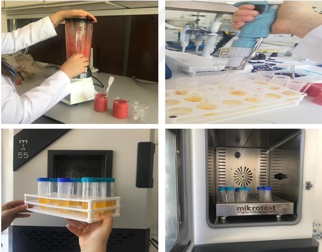
Şekil 3.24. Meyveden elde edilen likopen tayini aşamaları
