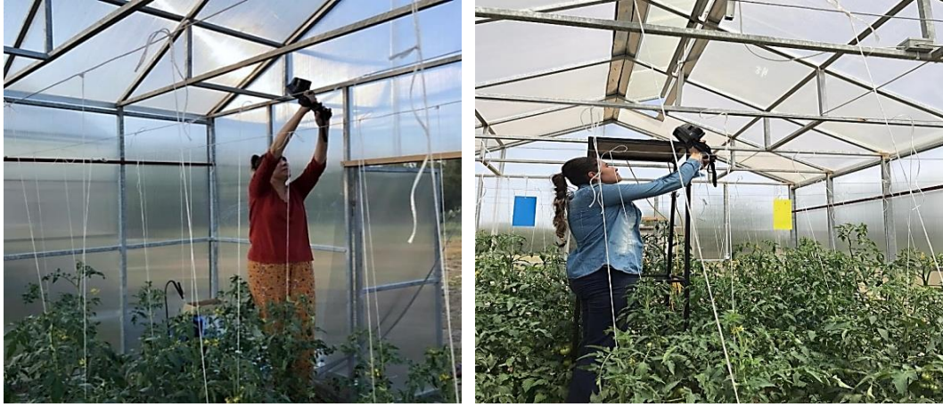
Şekil 3.9. Sera çatı sıcaklığının termal görüntülenmesi
