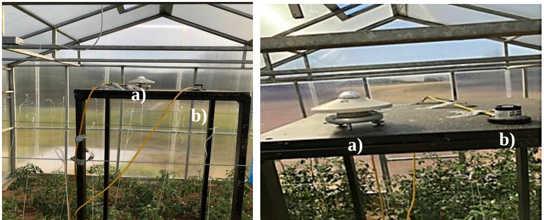
Şekil 3.3. Piranometre (a) ve quantum algılayıcıların (b) sera içi konumları
