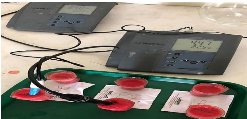
Şekil 3.23. Elde edilen örneklerden EC-pH ölçümü
