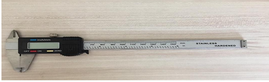
Şekil 3.20. Kök boğazı kalınlığını ölçmede kullanılan dijital kumpas
