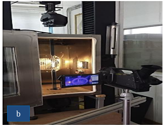
Şekil 2.19. a) Sera çatılarında cam ve metal konstrüksiyonun birleşme noktalarındaki termal görüntüleme; b) Termostatik odada PC malzeme çekme testi sırasında termal görüntüleme (Fuinaa vd. 2019)
