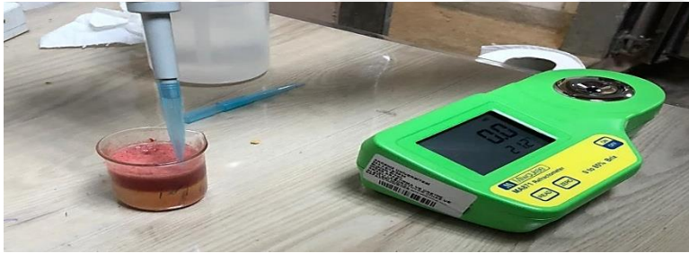
Şekil 3.22. SÇKM miktarını belirlemede kullanılan dijital refraktometre
