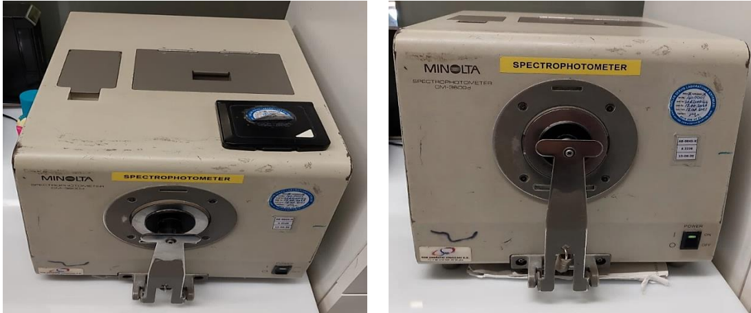
Şekil 3.12. Sararma indisi test cihazı (spektrofotometre)
