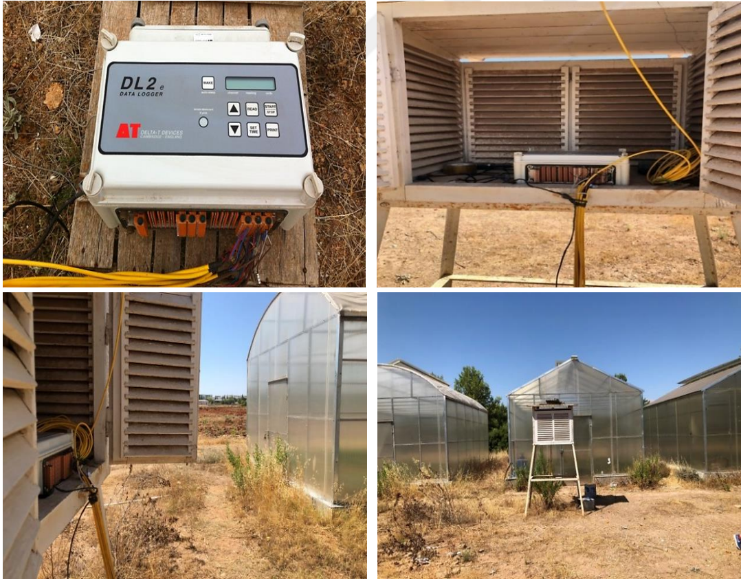
Şekil 3.4. Veri kayıt cihazı ve araştırma alanındaki konumu
