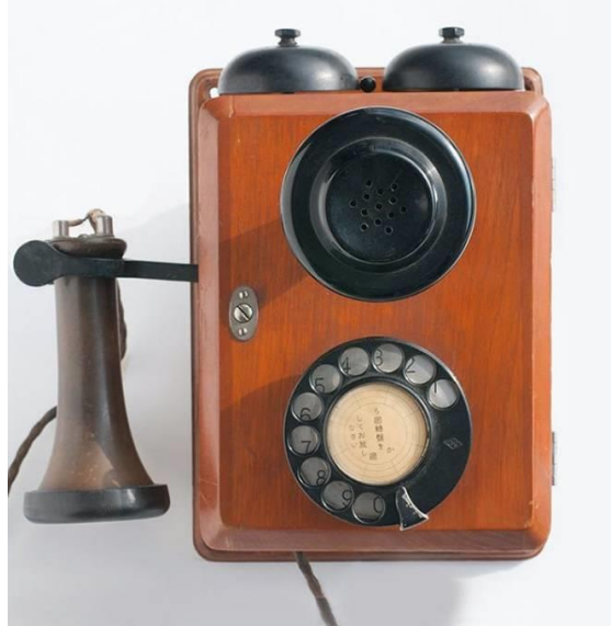
Görsel 2. NTT Firması tarafından geliştirilen “No.23 Otomatik Duvar Telefonu,” (NTT Group History, [5.12.2024]).
