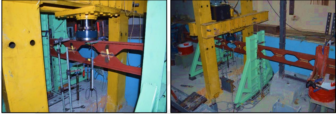
Şekil 4.1. Sinüsoidal boşluklu kiriş testi; tekil yükleme durumu
