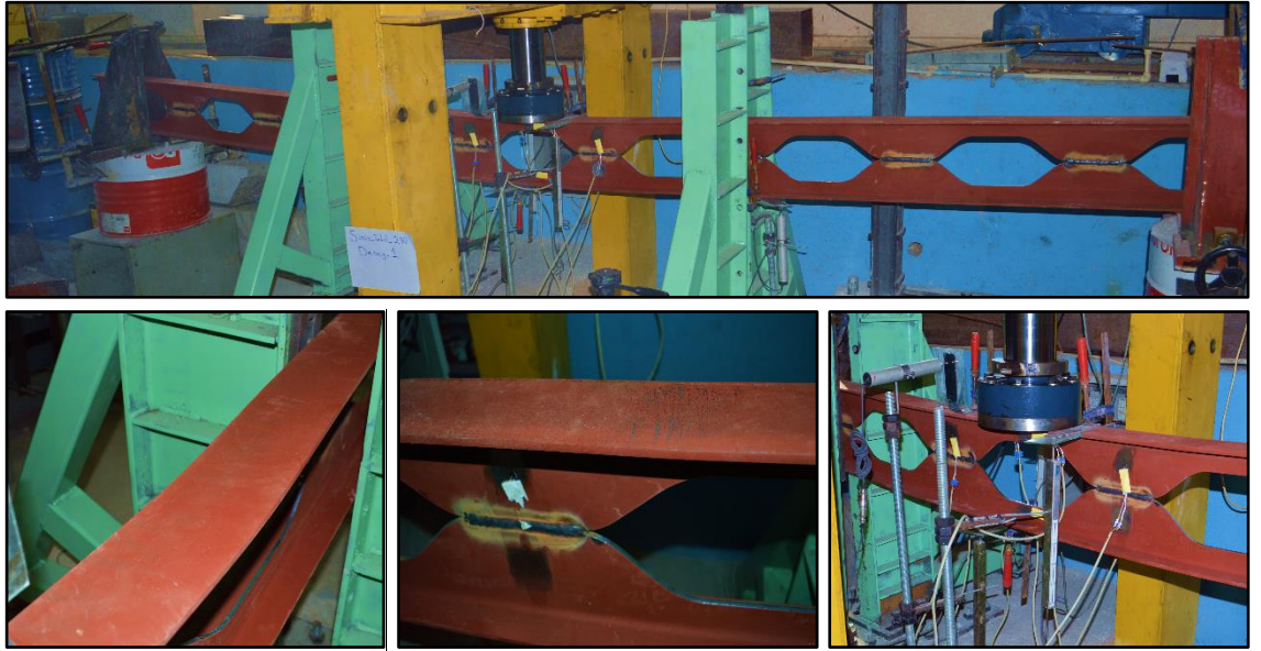
Şekil 4.8. IPE_SB_200 kirişleri deney fotoğrafları.
