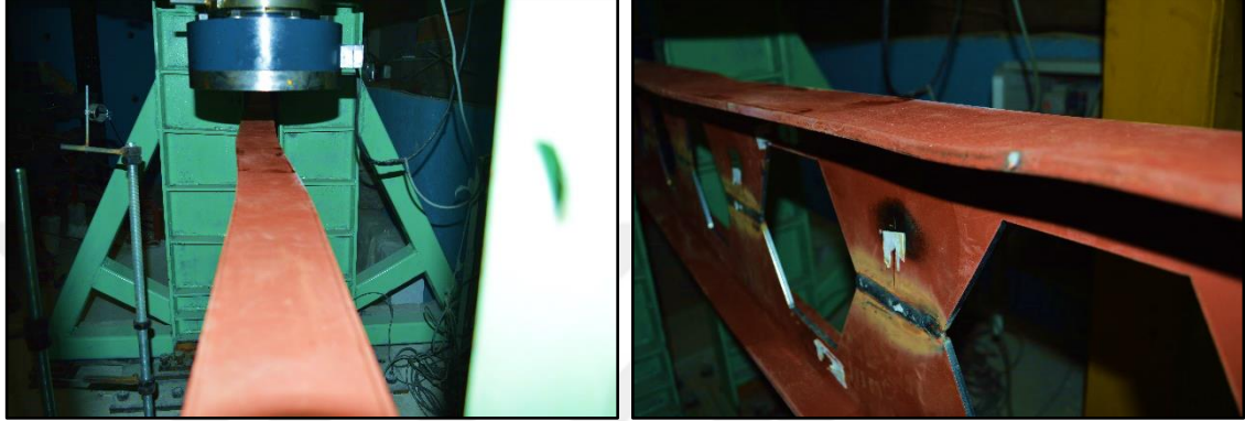
Şekil 4.13. IPE_PB_200_Test_2; yanal burkulma ve yerel burkulma durumu
