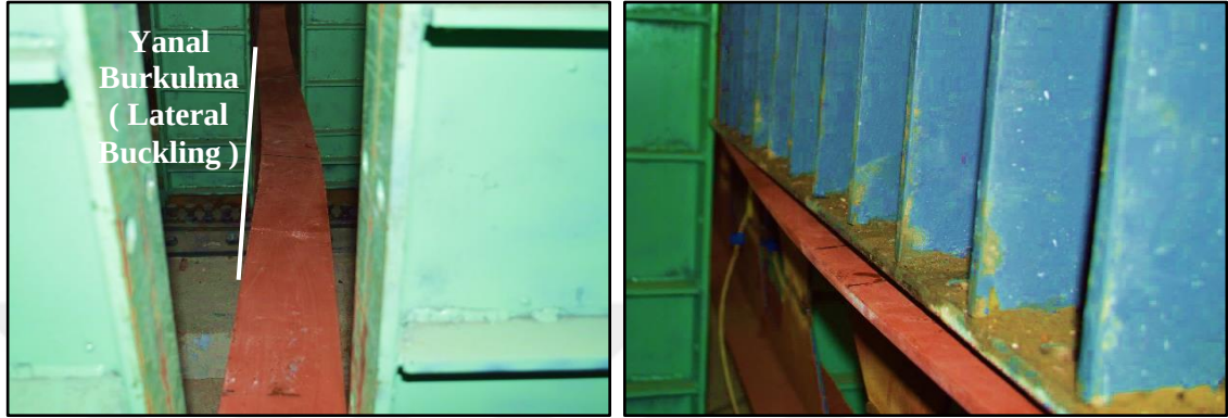
Şekil 4.40. IPE_PB_240_Test_1; yayılı yükleme altında göçme durumu
