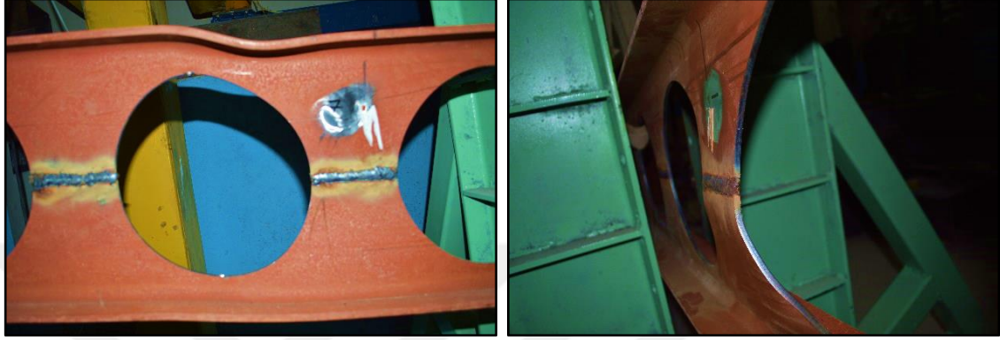
Şekil 4.50. IPE_DB_240_Test_2; yayılı yükleme altında göçme durumu
