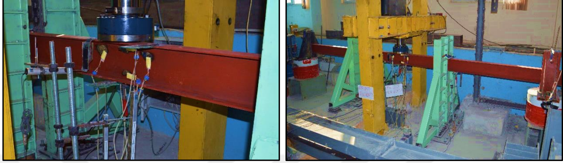
Şekil 4.25. Orijinal IPE200 kirişi testi; tekil yükleme durumu
