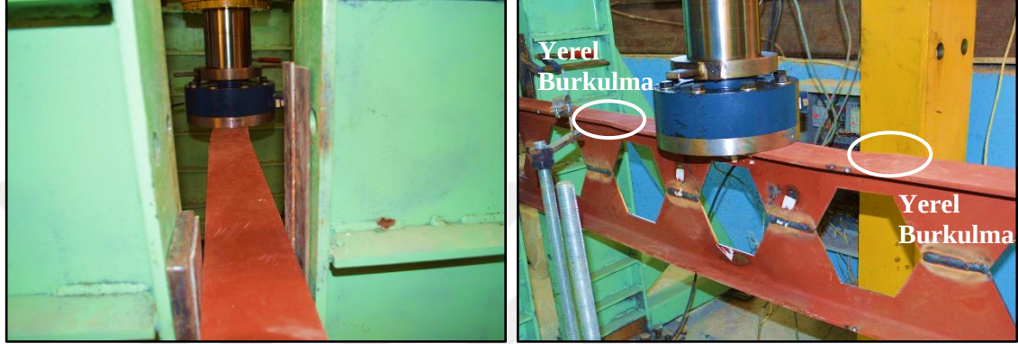
Şekil 4.11. IPE_PB_200_Test_1; yanal burkulma ve yerel burkulma
