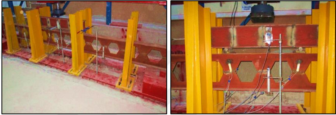
Şekil 4.66. IPE_PB_300; petek boşluklu kiriş deneyi; iki noktadan yükleme
