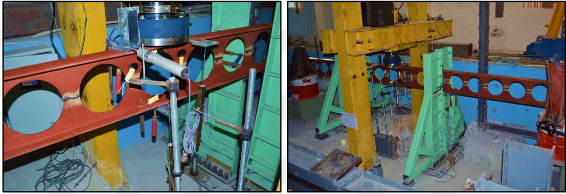
Şekil 4.17. Dairesel boşluklu kiriş testi; tekil yükleme durumu
