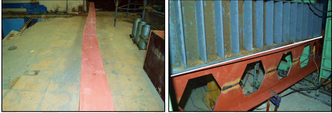
Şekil 4.42. IPE_PB_240_Test_2; yayılı yükleme altında göçme durumu
