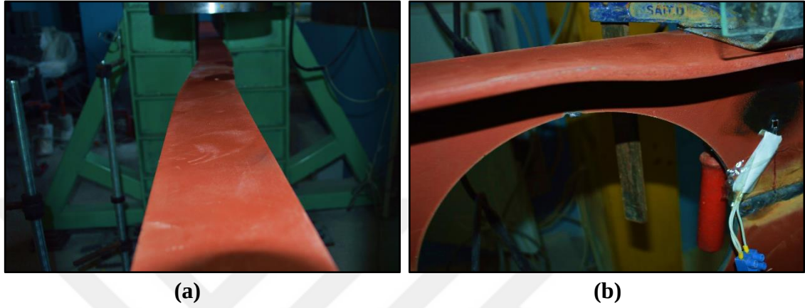
Şekil 4.21. IPE_DB_200_Test_2; a) Yanal burkulma b) Yerel burkulma
