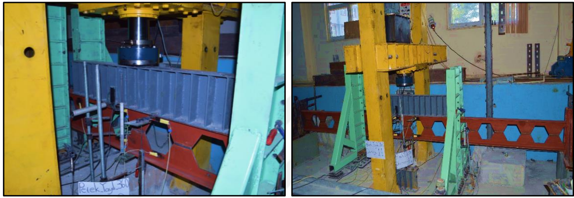
Şekil 4.38. IPE_PB_240; petek boşluklu kiriş deneyi; yayıllı yükleme durumu
