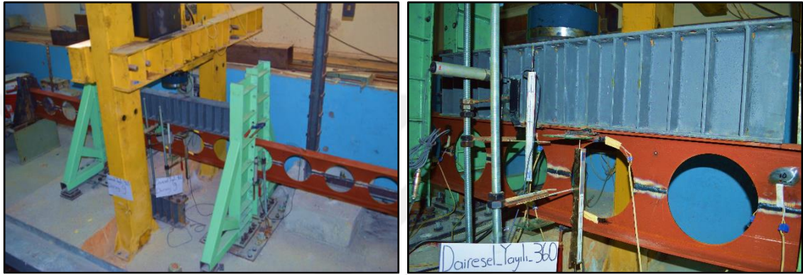
Şekil 4.46. IPE_DB_240 dairesele boşluklu kiriş deneyi; yayılı yükleme durumu
