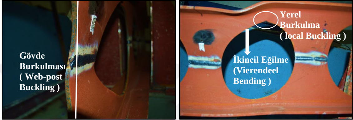
Şekil 4.48. IPE_DB_240_Test_1; yayılı yük altında göçme durumu
