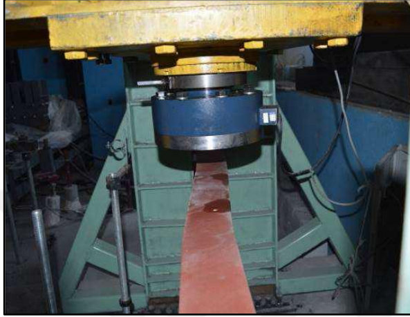
Şekil 4.3. IPE_SB_200_Test_1; tekil yükleme altında yanal burkulma durumu
