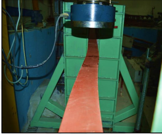
Şekil 4.5. IPE_SB_200_Test_2; tekil yükleme altında yanal burkulma durumu
