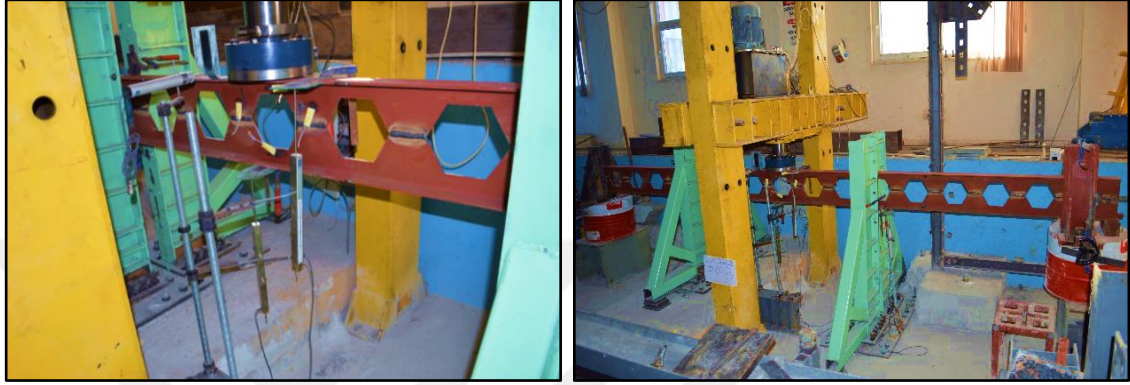
Şekil 4.9. Petek boşluklu kiriş testi; tekil yükleme durumu
