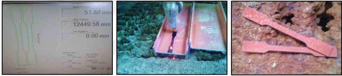
Şekil 3.24. GYA kirişlerden alınan numune örnekleri
