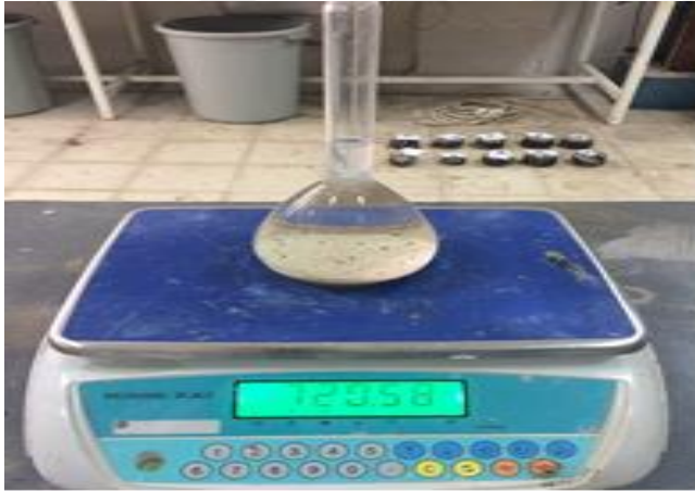
Şekil 3.3. Piknometre ve Agreganın Hassas Terazide Tartılması
