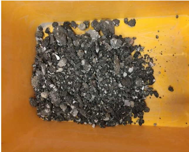
Şekil 3.6. Sahadan Kazınmış Asfalt
