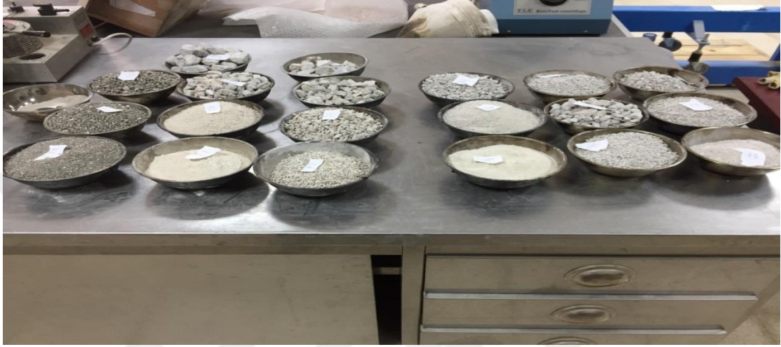
Şekil 3.23. Elek Açıklığına Göre Sınıflandırılan Agregalar
