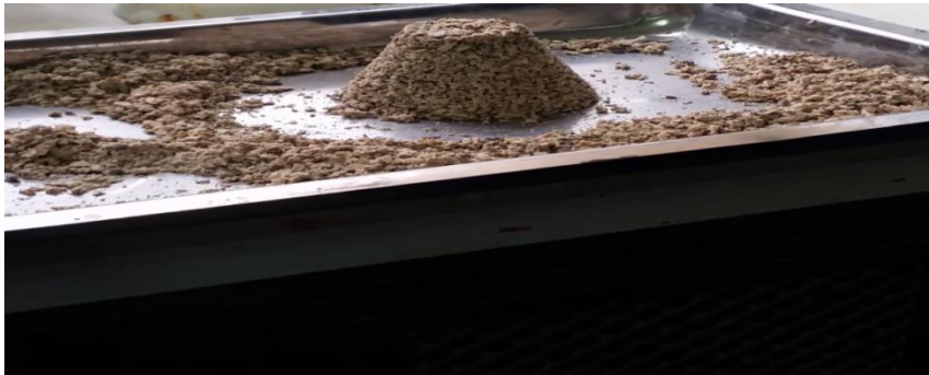
Şekil 3.4. Kesik Koni ile Kıvam Belirlenmesi
