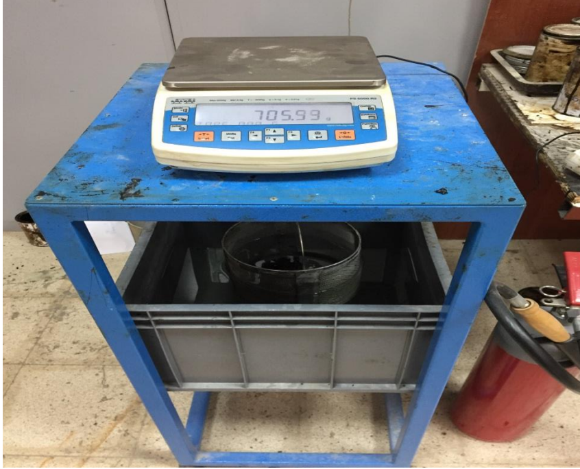
Şekil 4.9. Sudaki Ağırlığın Bulunması
