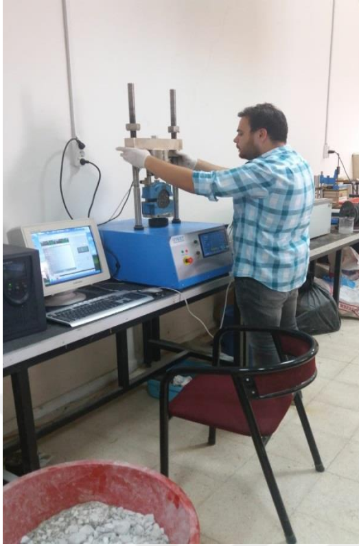
Şekil 3.27. Marshall Stabilite Test Cihazı
