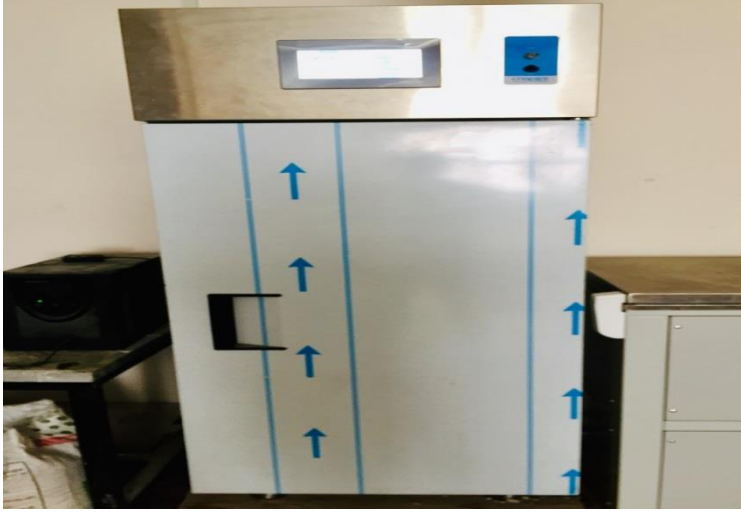
Şekil 3.31. Donma Çözünme Kabini
