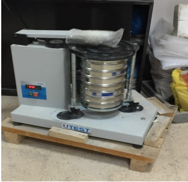
Şekil 3.20. Agrega Eleme İşlemi
