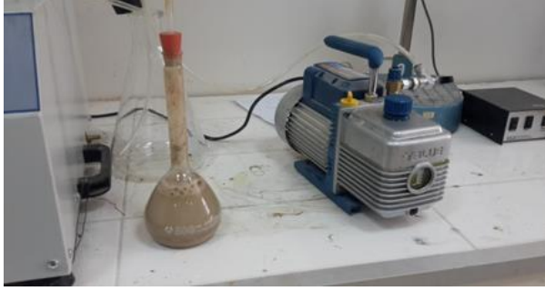
Şekil 3.2. Vakumlu Desikatör Aracılığıyla Havanın Alınması
