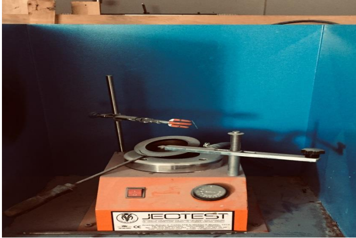
Şekil 3.18. Parlama Noktası Deney Cihazı
