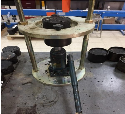
Şekil 3.26. Hazırlanan Marshall Numuneleri
