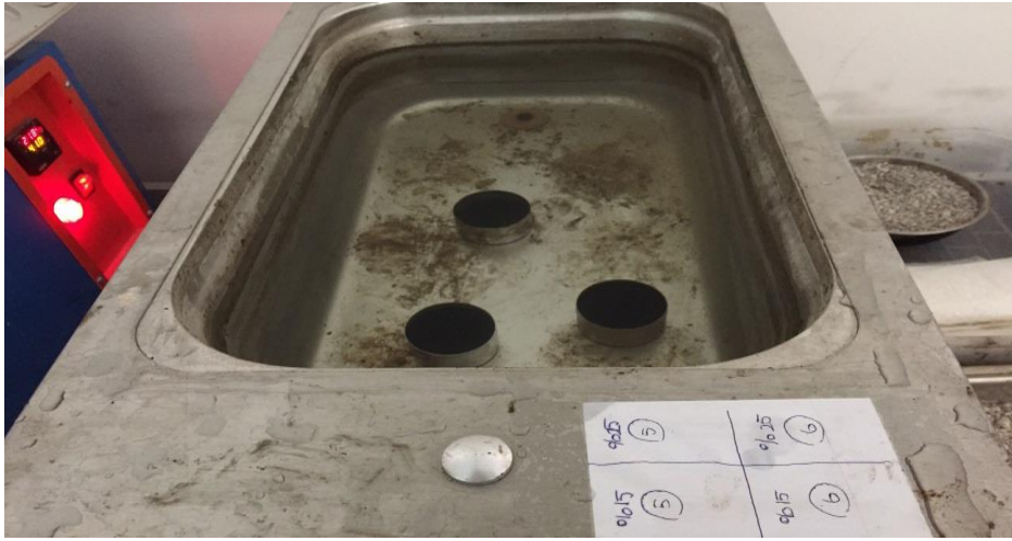
Şekil 3.15. Numunelerin 25^0\text{ C} Su Banyosunda Bekletilmesi
