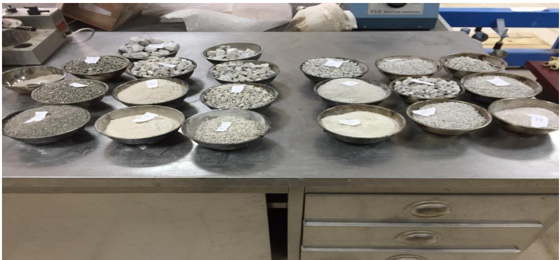
Şekil 3.21. Boyutlarına Göre Sınıflandırılan Agregalar
