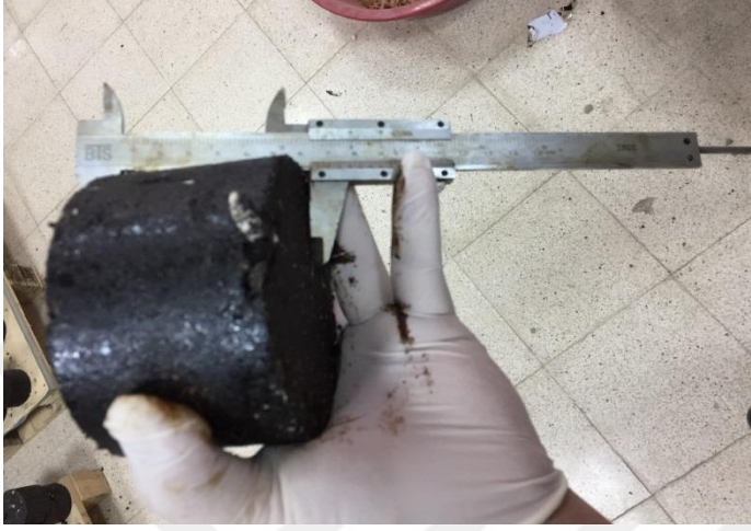
Şekil 4.8. Numunelerin Yüksekliklerinin Ölçölmesi
