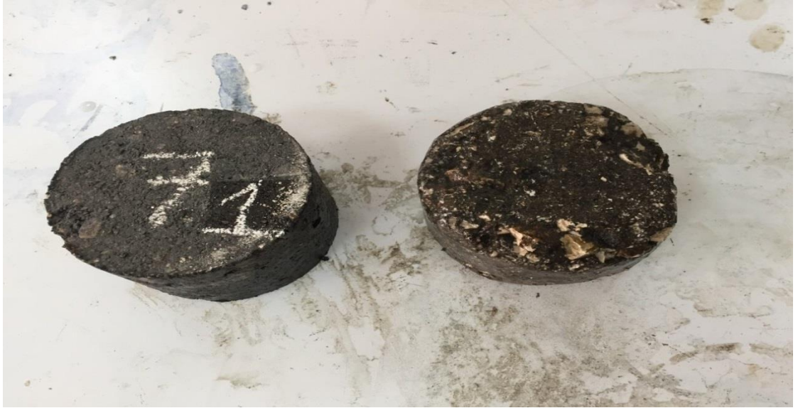
Şekil 4.47. Cantabro Deneyi Öncesi ve Sonrası Numune
