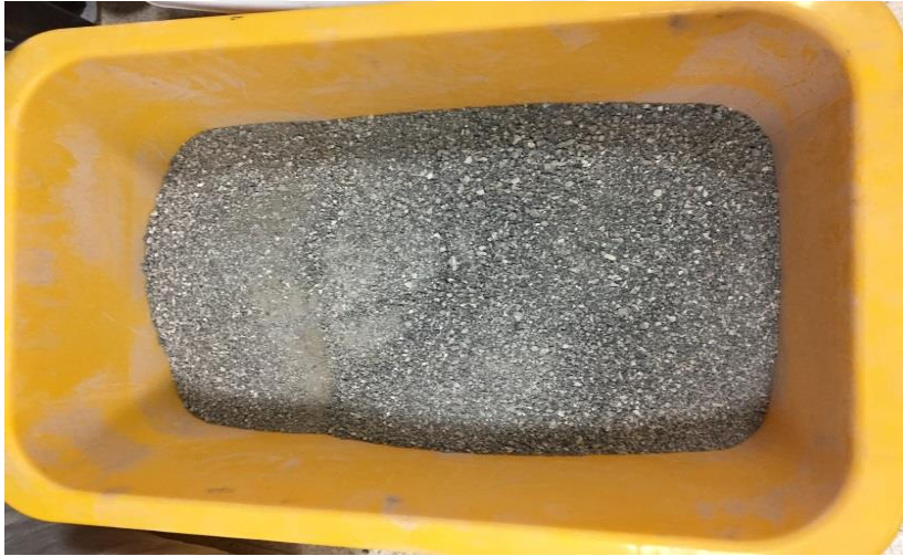
Şekil 3.8. Konkasörde Kırıldıktan Sonra Kazınmış Asfalt
