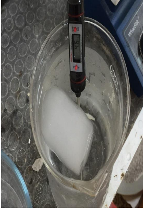
Şekil 3.13. Yumuşama Noktası Deney Düzenegi
