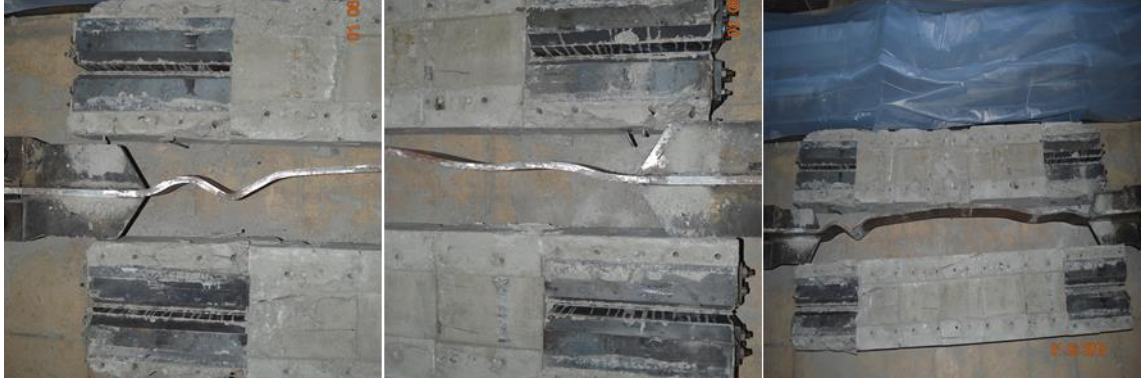
Şekil 4.24. Deney elemanı 4'ün ÇE'sinde meydana gelen burkulmalar (112M820 numaralı projeden alınmıştır)
