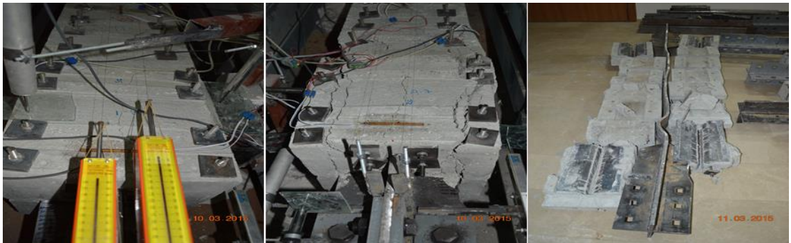
Şekil 4.18. Deney elemanı 3'de meydana gelen hasarlar
