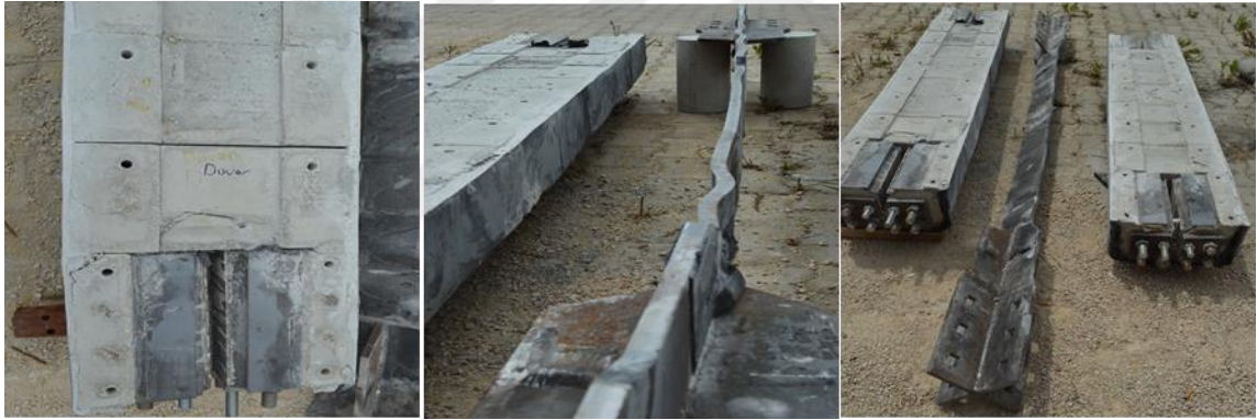
Şekil 4.44. Deney elemanı 7'de meydana gelen hasarlar (112M820 numaralı projeden alınmıştır)
