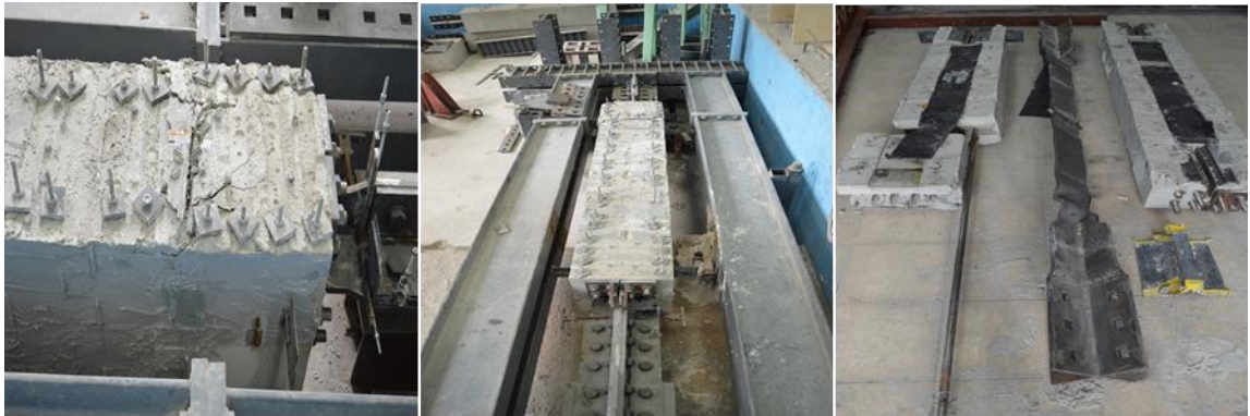
Şekil 4.37. Deney elemanı 6'da meydana gelen hasarlar (112M820 numaralı projeden alınmıştır)
