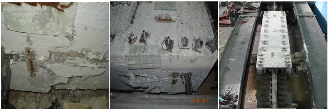
Şekil 4.31. Deney elemanı 5'in BEM'inde meydana gelen hasarlar (112M820 numaralı projeden alınmıştır)
