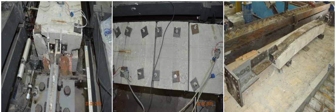
Şekil 4.12. Deney elemanı 2’de meydana gelen global burkulma (112M820 numaralı projeden alınmıştır)
