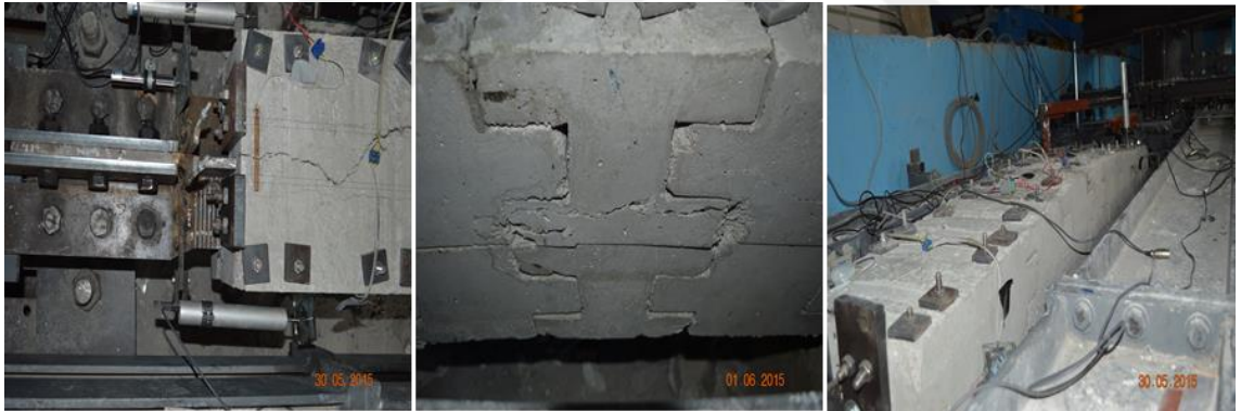
Şekil 4.25. Deney elemanı 4'ün BEM'inde meydana gelen hasarlar (112M820 numaralı projeden alınmıştır)
