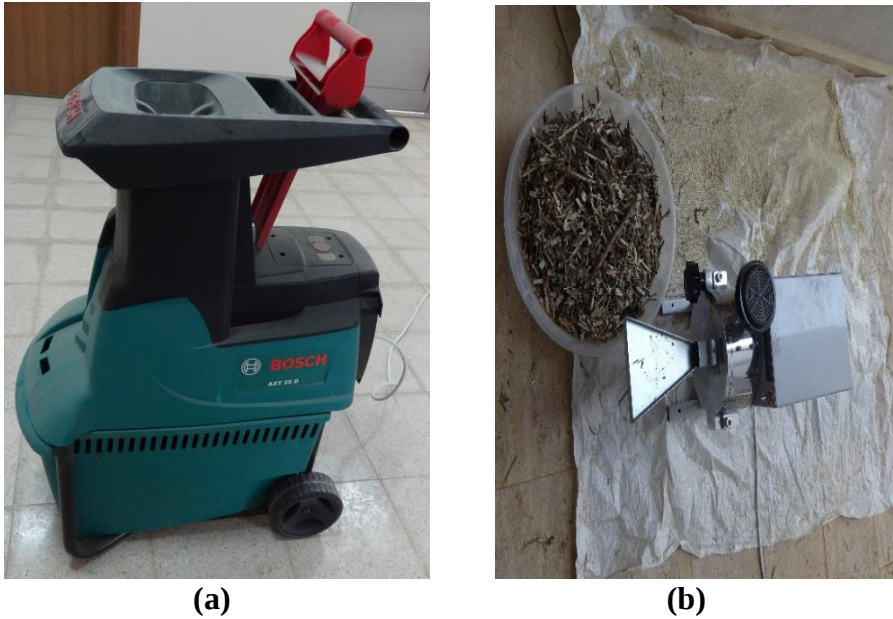
Şekil 3.2. a) Kırıcıda atık ufalama; b) Değirmende atık öğütme
