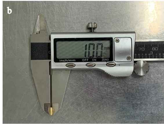
Resim 15. (a) Kesme işleminden sonra elde edilen dentin diskleri, (b) dijital kumpas ile ölçümleri
