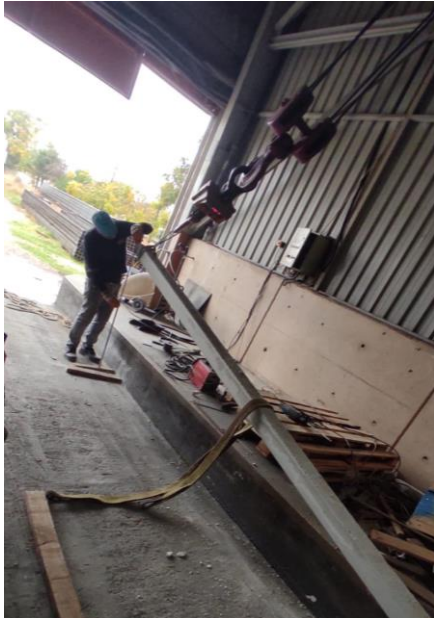
Şekil 4.44. Eğik çekme kuvveti etkisinde deplasman ölçüm görüntüsü
