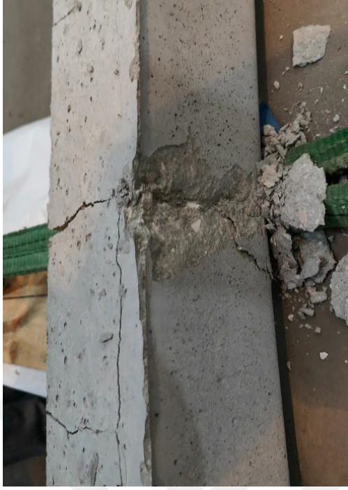
Şekil 4.23. 4 toronlu 6 ton ÖBK'de eğilme deneyi sonucu oluşan kırılma
