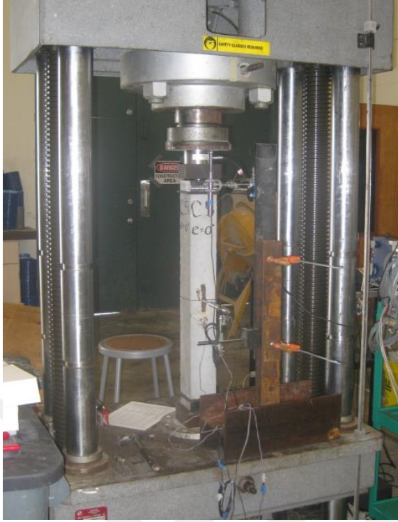
Şekil 2.5. Daniel A. Grijalba (2011) tarafından yapılan çalışmada test edilen kolonlar için deney düzeneği
