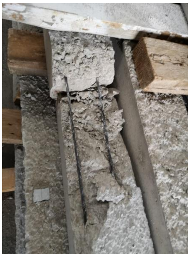
Şekil 4.40. 4 toronlu 8 ton öngerilmeli ÖBK'nin eğik çekme kuvveti etkisinde kırılmış görüntüsü
