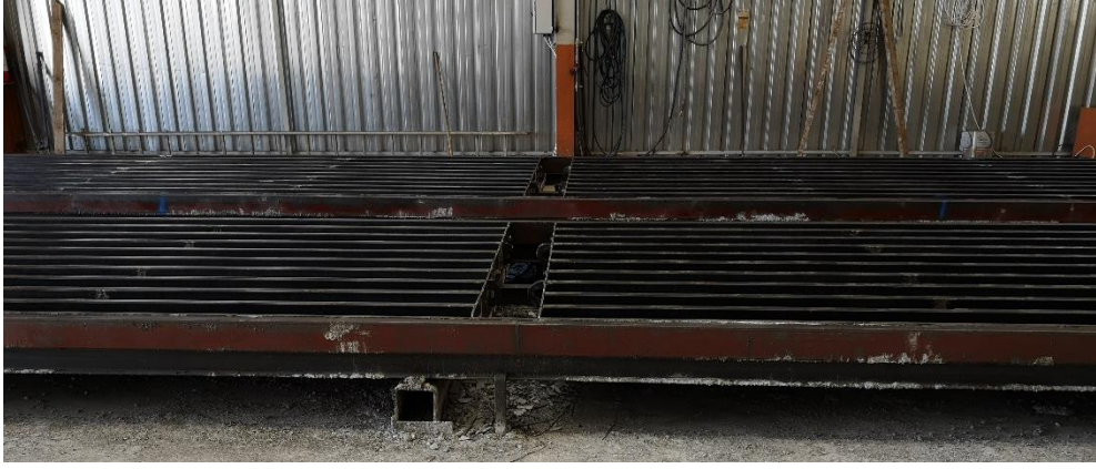
Şekil 3.11. Öngerilmeli beton kolon üretim kalıbı yandan görünüş
