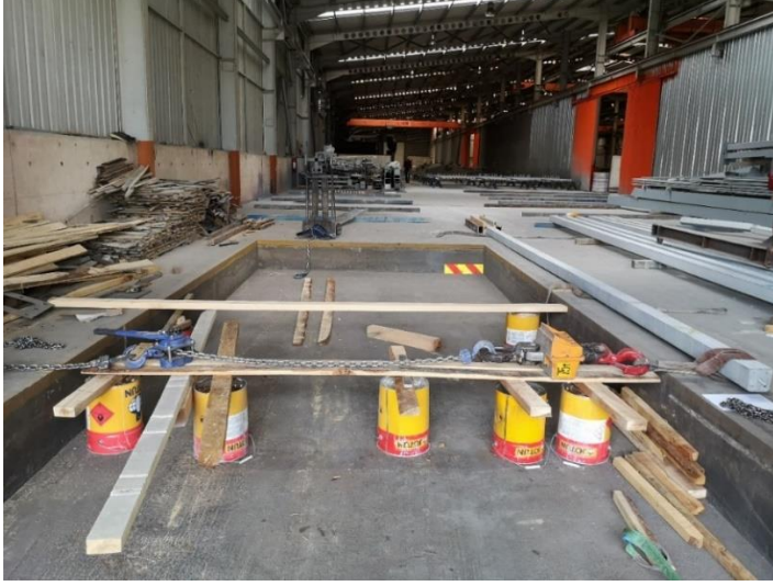
Şekil 3.28. Gerçekleştirilen yatay çekme kuvveti etkisindeki kırılma deneyi görüntüsü
