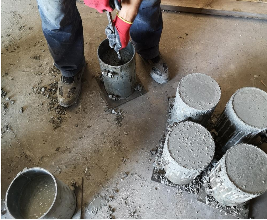
Şekil 3.13. Basınç deneyi için beton numune alınması
