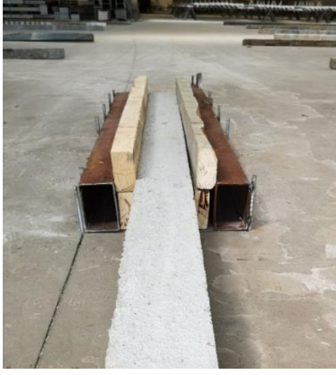
Şekil 3.22. 1,5 metre gömülü ankastre mesnet
