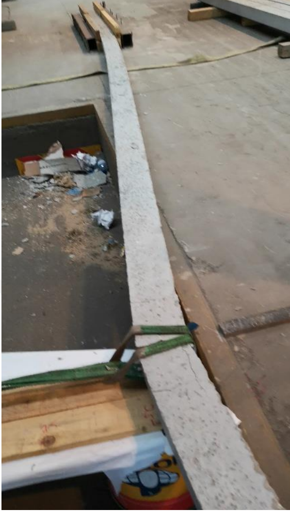
Şekil 4.22. Eğilme deneyi esnasında oluşan kolondaki deplasman görüntüsü
