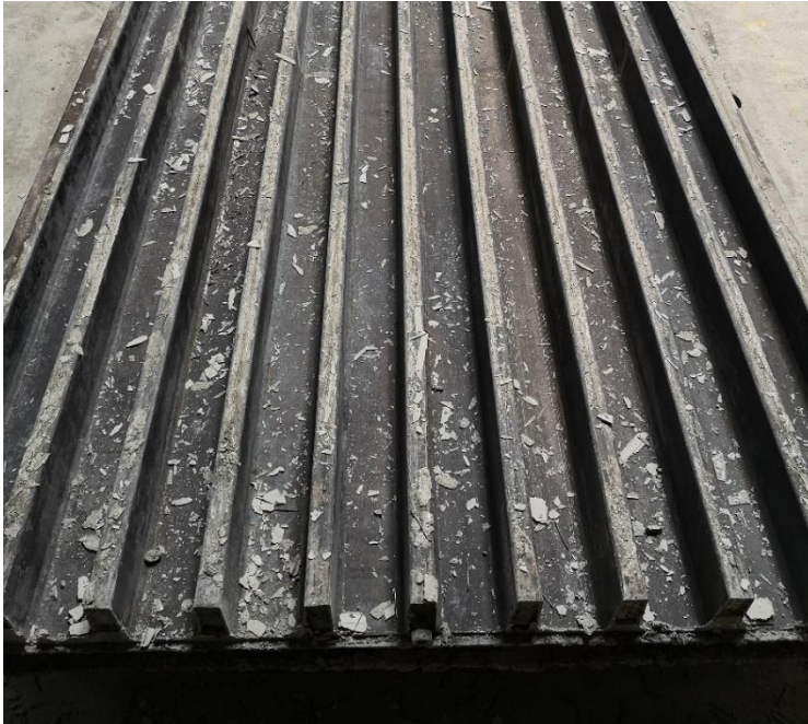
Şekil 3.10. Öngerilmeli beton kolon üretim kalıbı üstten görünüş
