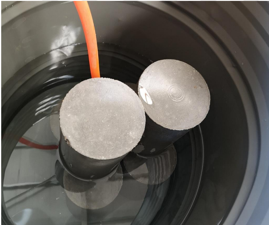
Şekil 3.14. Su dolu tankta bekletilen numuneler
