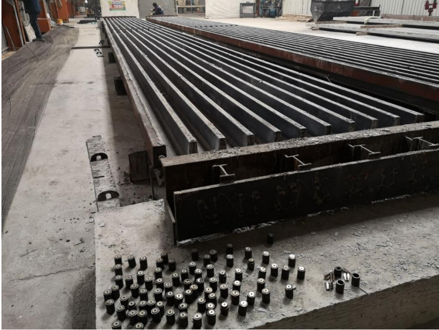
Şekil 3.7. ÖBK'lerin üretim kalıbı ile öngerme çekirdek ve kovanı
