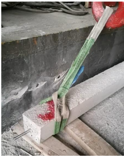
Şekil 4.38. 8 toronlu ÖBK eğik çekme kuvveti etkisindeki kırılma deneyi görüntüsü
