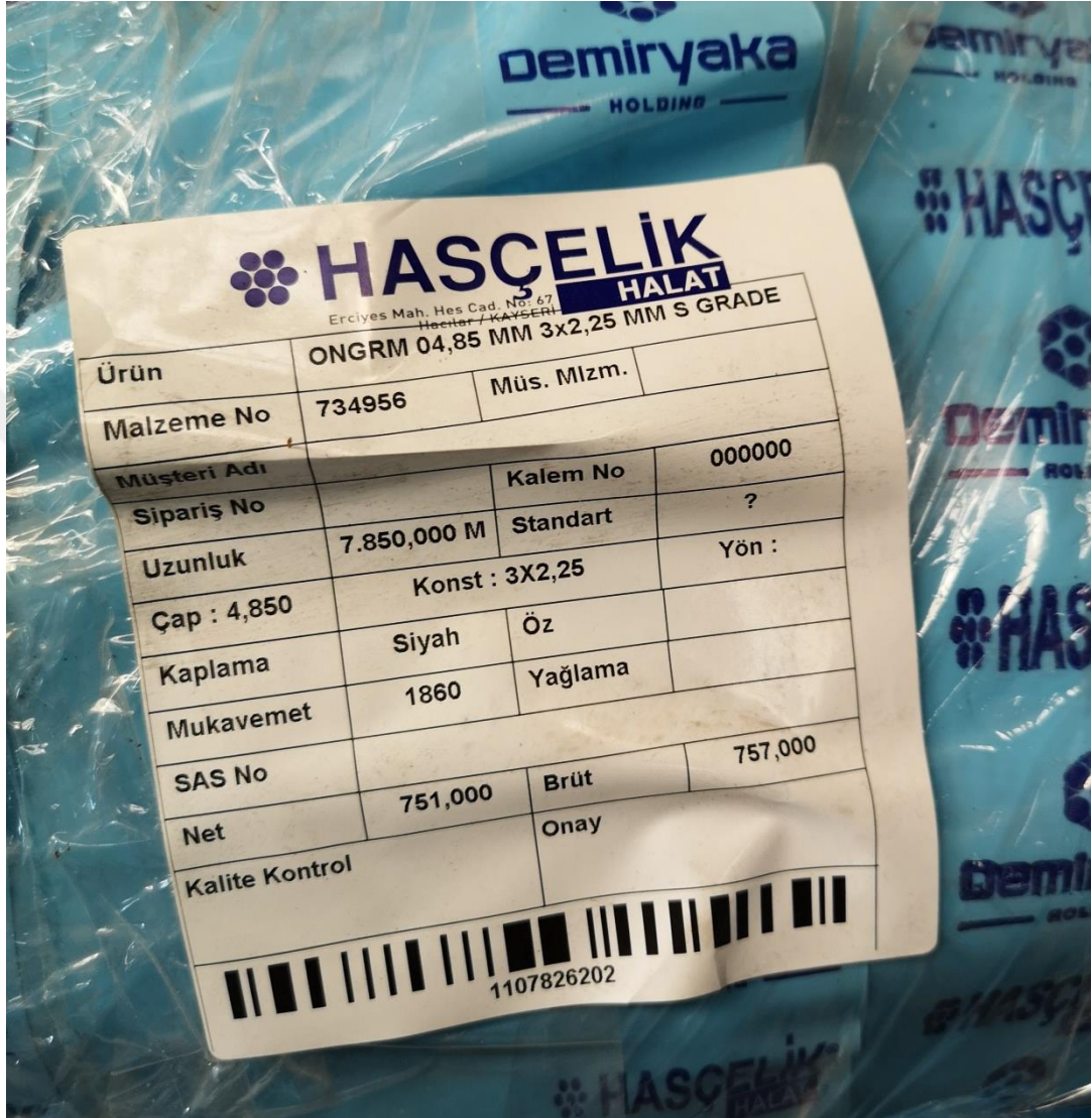
Şekil 3.5. Temin edilen öngerme toronun üstünde özellikleri gösterilen barkod
