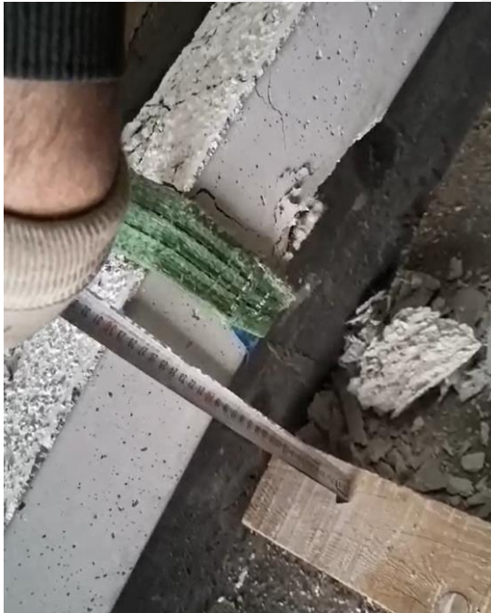
Şekil 4.28. Eğilme deneyi deplasman ölçüm görüntüsü
