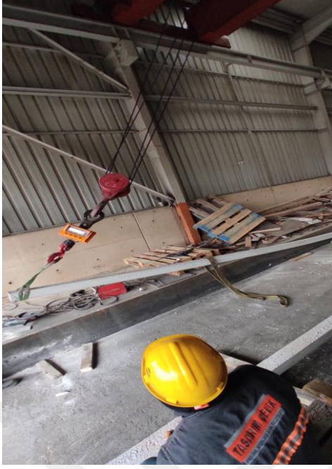
Şekil 3.30. Gerçekleştirilen eğik çekme kuvveti etkisindeki kırılma deneyi görüntüsü
