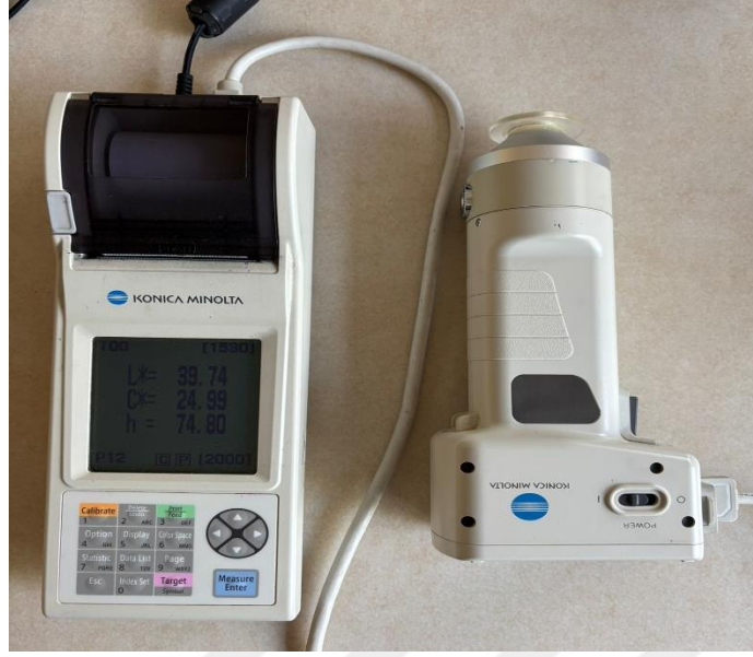
Şekil 3.15. Minolta marka renk ölçüm cihazı
