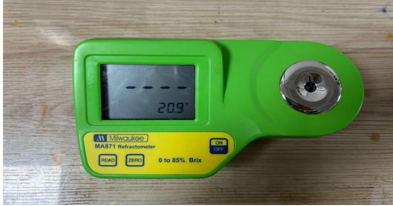
Şekil 3.13. SÇKM miktarının ölçümünde kullanılan Milwaukee MA871 model dijital refraktometre
