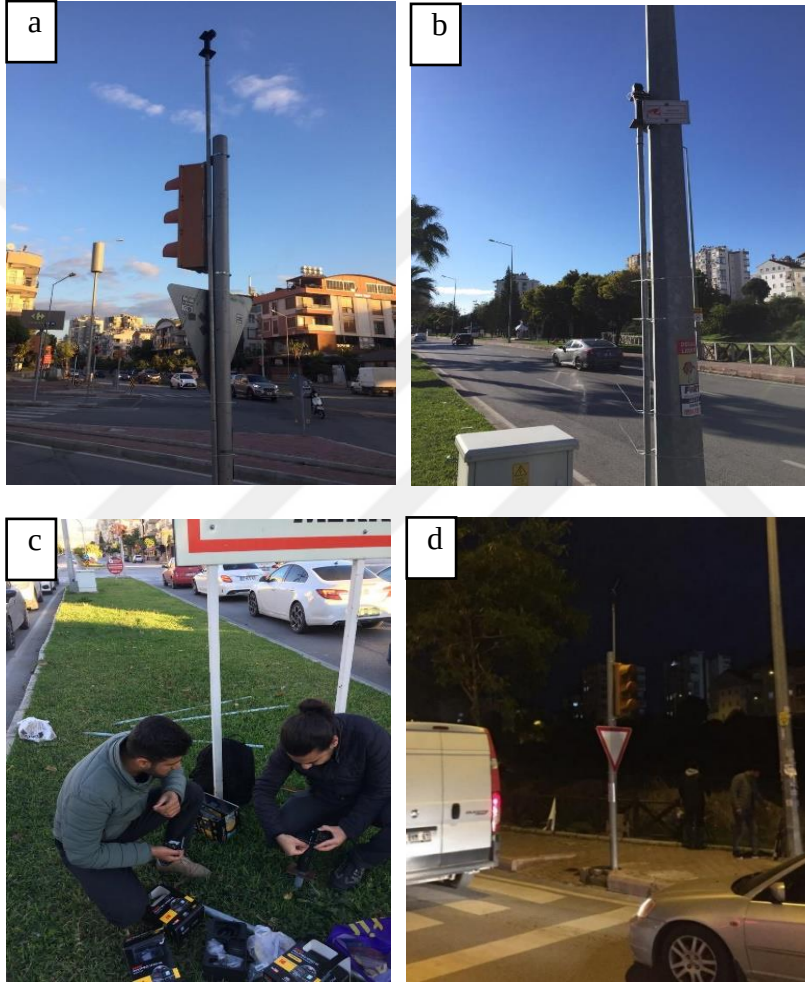
Şekil 3.11. Saha çalışmaları; a) Kamera ve direk sisteminin yerleşimi; b) Başka bir güne ait kamera ve sistem konumu; c) Kamera ayarlarının yapılması ve kameranin kurulum için hazırlanması; d) Akşam sayımlarından bir tanesine ait kamera ve sistem konumu
