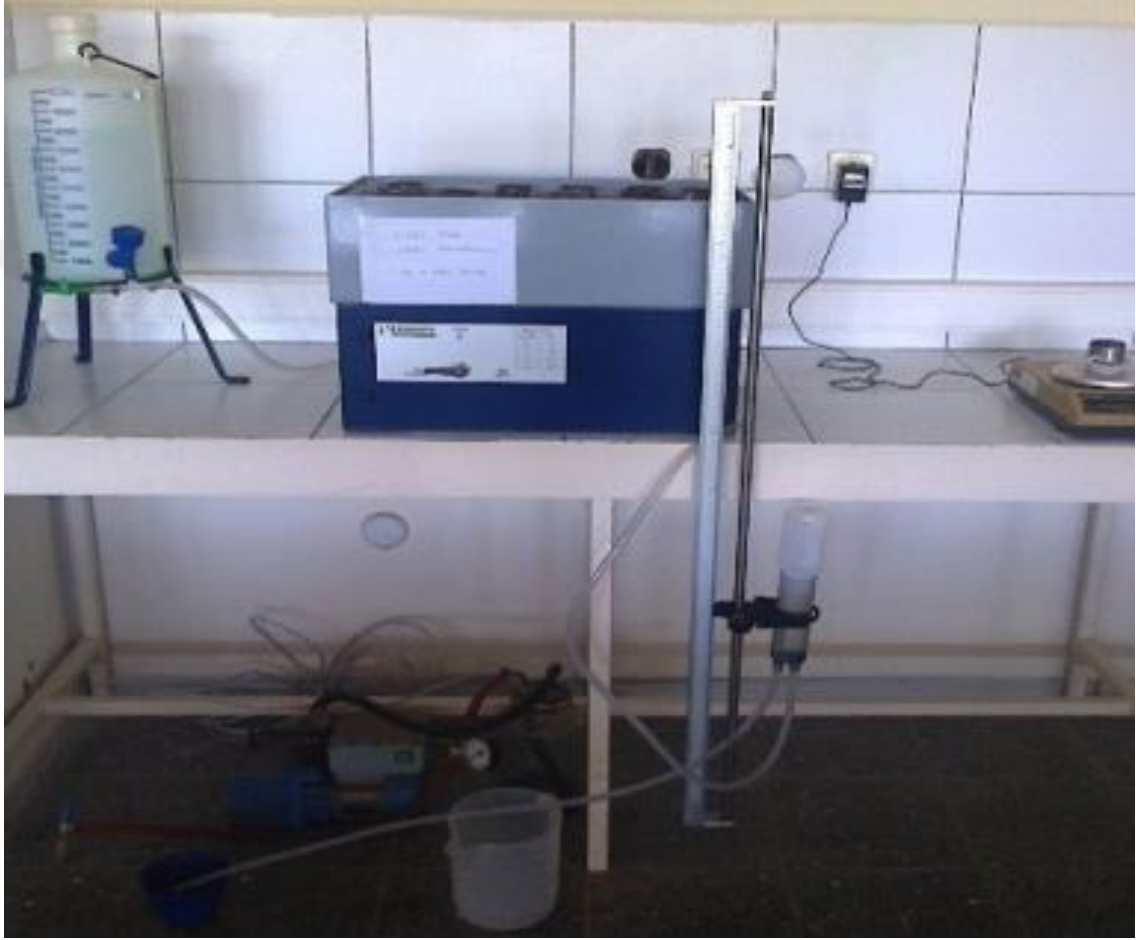
Şekil 3.5. Farklı pF değerlerinde tutulan su miktarının belirlenmesinde kullanılan Sand-box aletinin görünümü.
