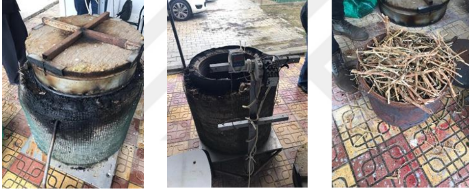
Şekil 3.10. Yavaş piroliz deney düzeneği
