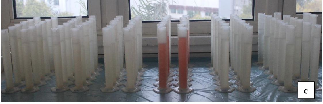
Şekil 3.6. a) Mikroskop altında nematod yumurtalarının görüntüsü, b) Geliştirilmiş Baermann Huni Yöntemi ile toprakların eleğe alınmış hali, c) toprakların suyunun mezurlara alınmış hali
