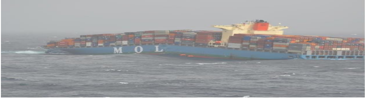
Fotoğraf 2.3 MOL COMFORT İkiye Ayrılma Görüntüsü 115
