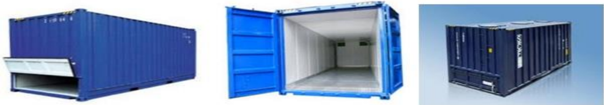
Fotoğraf 1.9 Yük Konteyneri ve Doldurma-Boşaltma Kapakları
