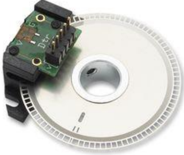
Şekil 4.6. Açısal hız bilgisi için kullanılan sensörler
