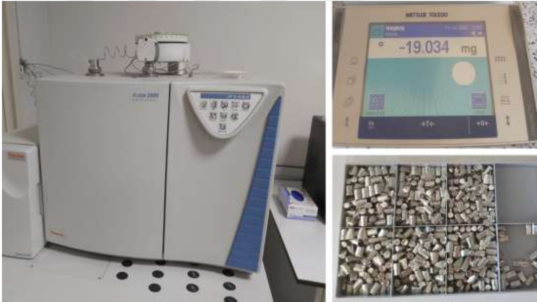
Şekil 3. IRMS- İzotop oranı kütle spektrometrisi
