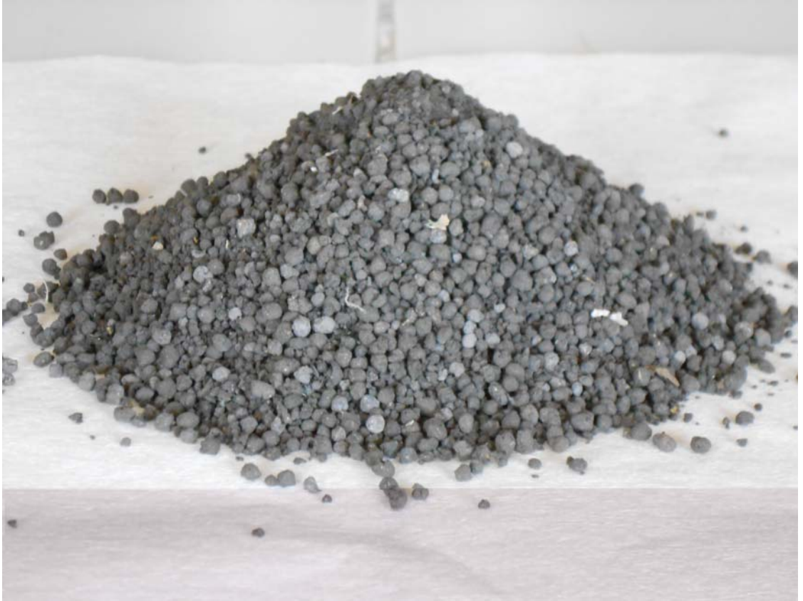
Şekil 3.2. Denemelerde kullanılan kurutulmuş ve stabilize edilmiş arıtma çamuru
