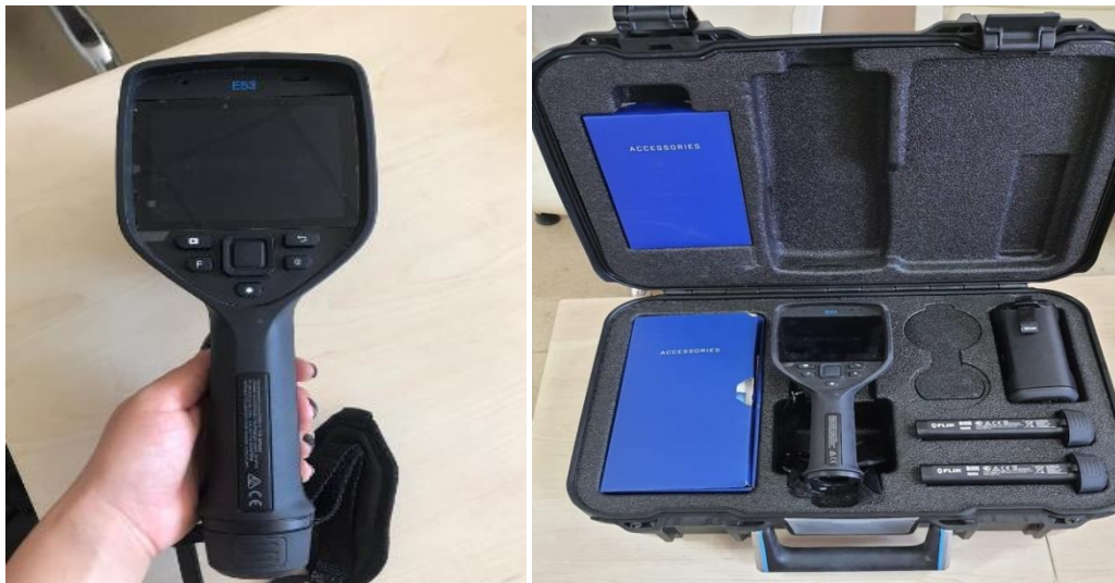
Şekil 3.3. Çalışmada kullanılan FLIR E53 model termal kamera
