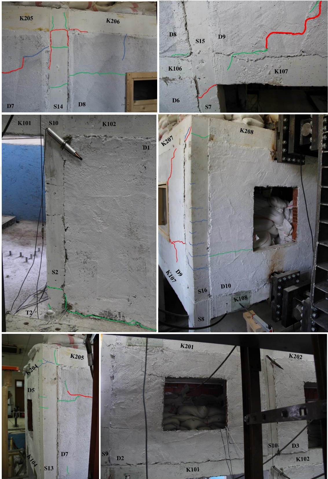
Şekil 4.4. Deney sırasında (%1.0 GKÖÖ'da) RDE'de gözlenen hasarlar
