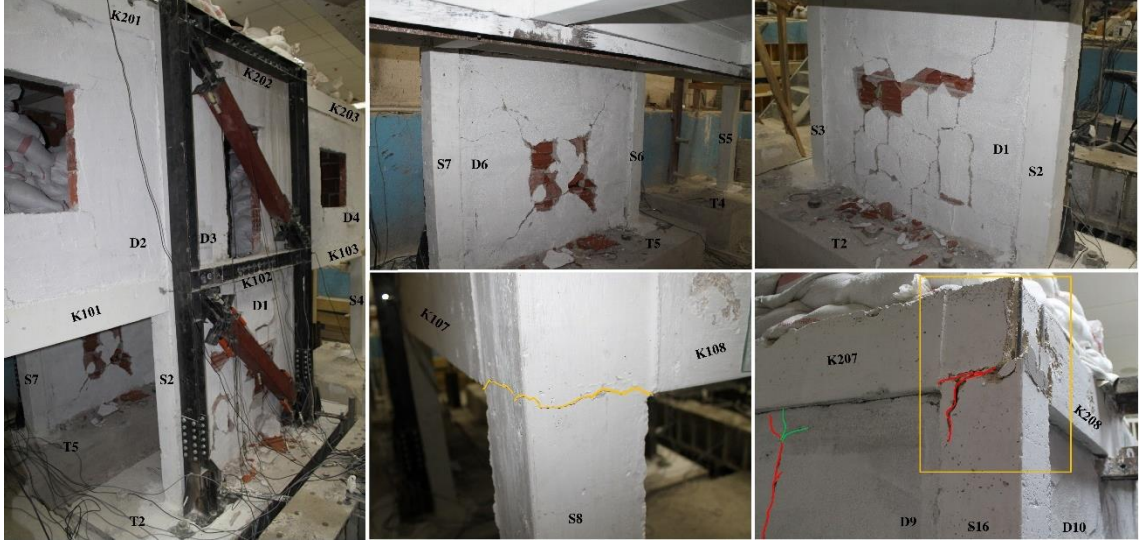
Şekil 4.45. Deney sırasında (%1.5 GKÖO'da) GDE-3'te gözlenen hasarlar
