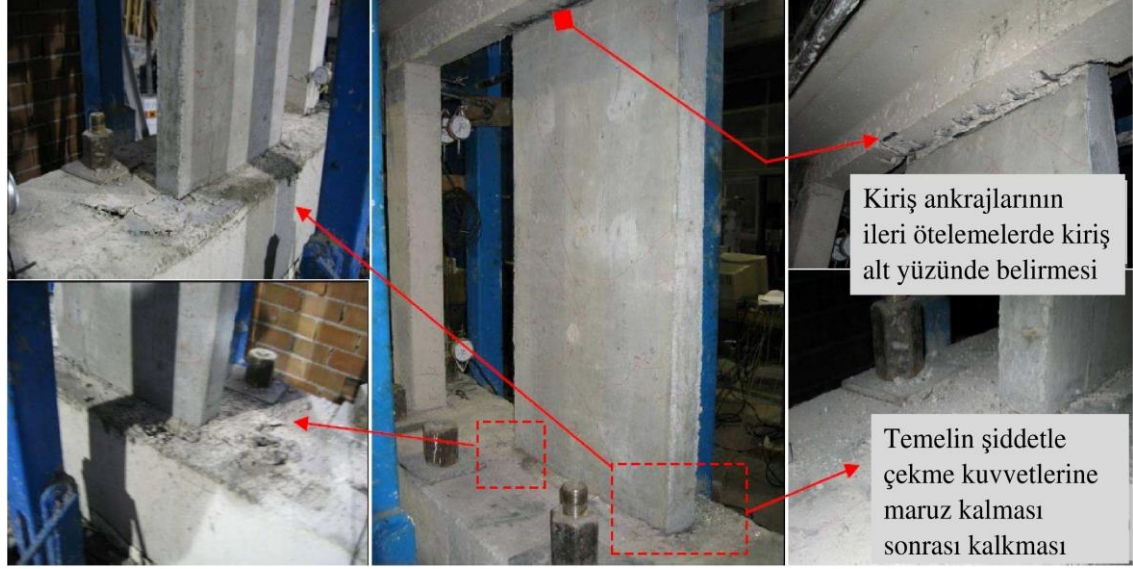
Şekil 2.4. Dış perde duvarla güçlendirme deneyi sırasında oluşan hasarlar (Binici 2010)
