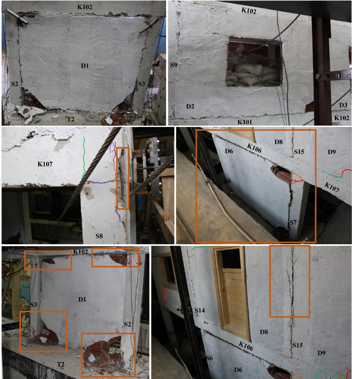
Şekil 4.7. Deney sırasında (%2.5 GKÖÖ'da) RDE'de gözlenen hasarlar
