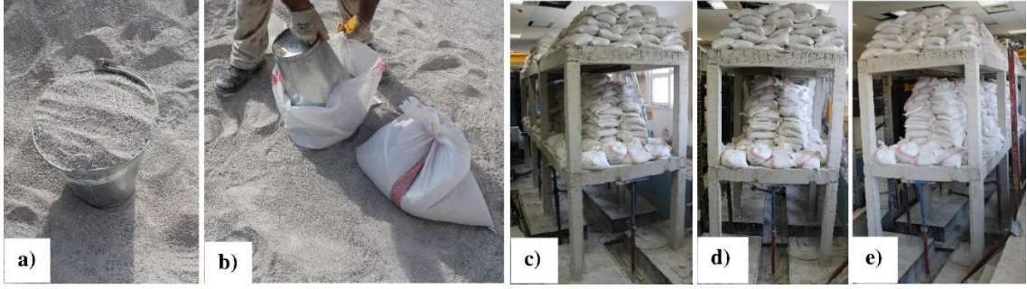
Şekil 3.17. Yapıya düşey yükleme için kum torbalarının yüklenmesi a); b) kumun çuvallara doldurulması (her bir çuval 25 kg olacak şekilde); c); d); e) kum torbaları katlara yerleştirildikten sonra
