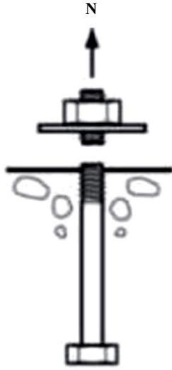
Şekil 8.14. Çekme etkisinde çeliğin kopması (ACI, 2014)
