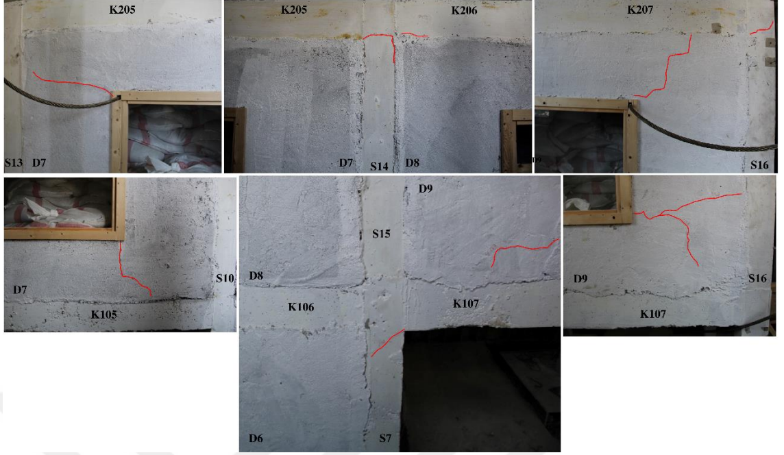
Şekil 4.2. Deney sırasında (%0.3 GKÖO’da) RDE’de gözlenen hasarlar
