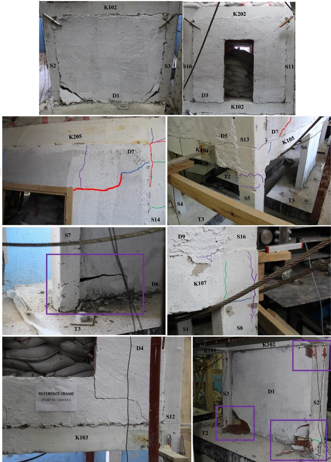
Şekil 4.6. Deney sırasında (%2.0 GKÖÖ'da) RDE'de gözlenen hasarlar
