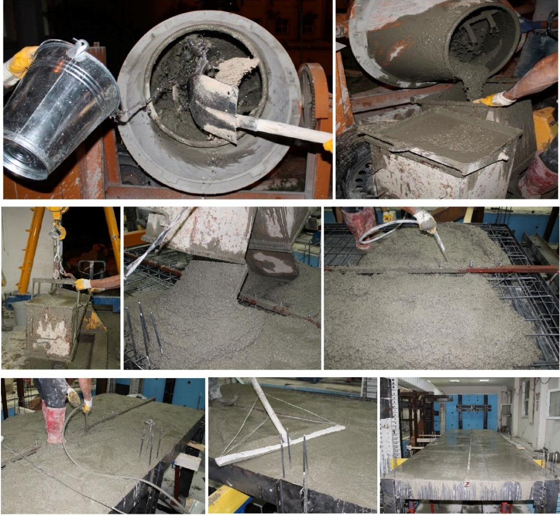
Şekil 3.13. Birinci kat beton dökümü
