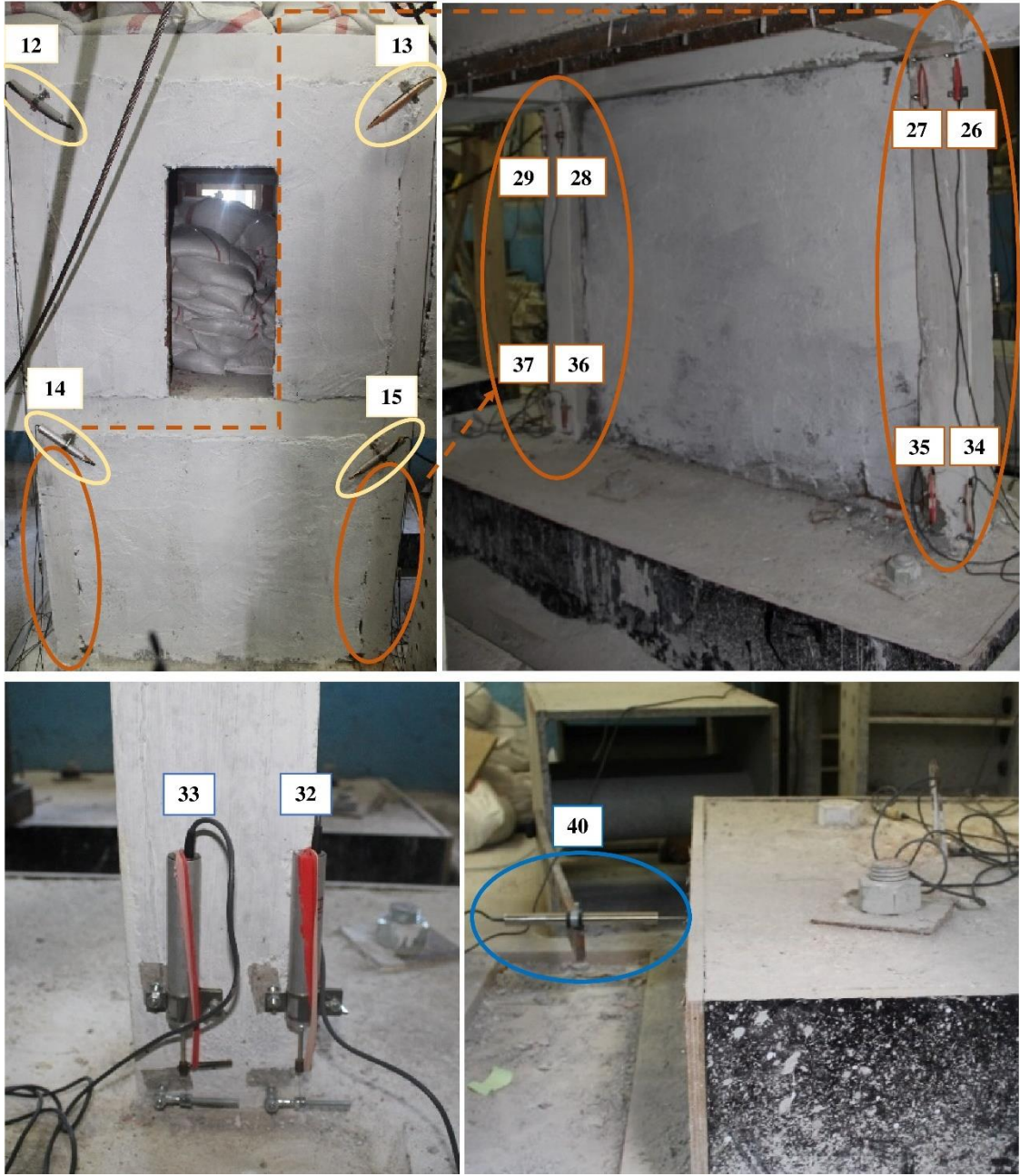
Şekil 3.41. RDE'ye ait ölçüm cihazlarının fotoğrafları (3'üncü kısım)
