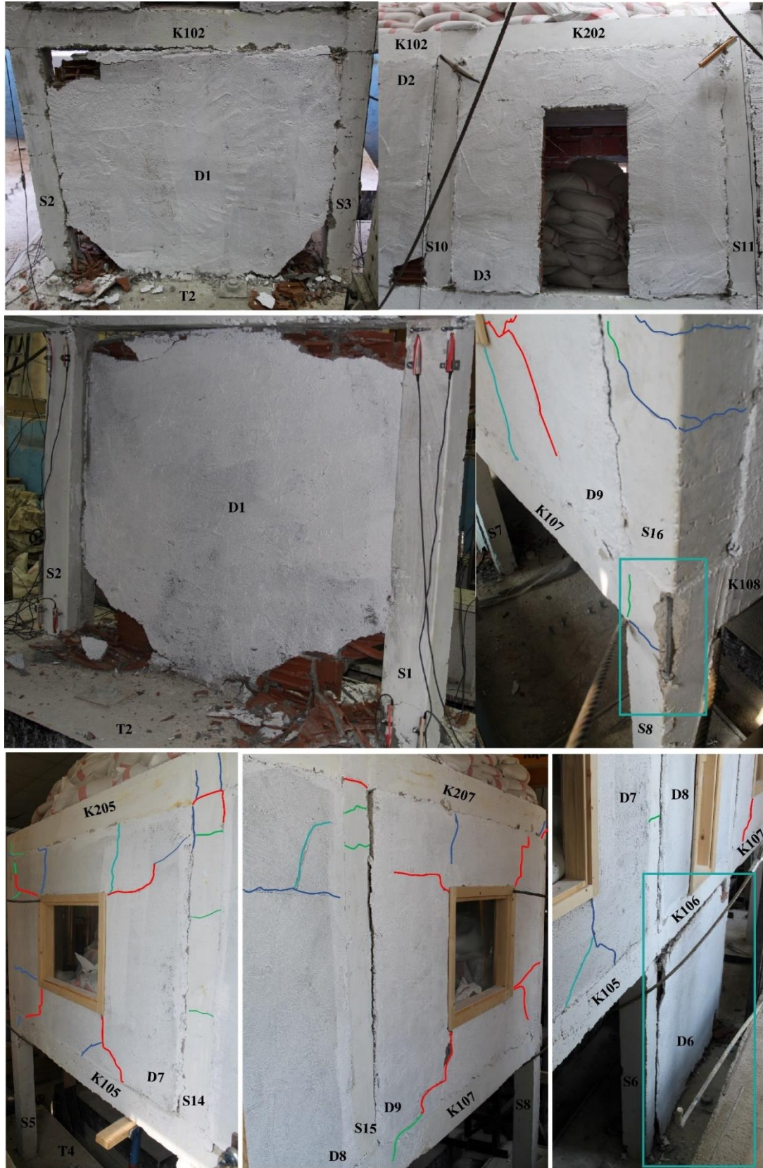
Şekil 4.8. Deney sırasında (%3.0 GKÖÖ'da) RDE'de gözlenen hasarlar
