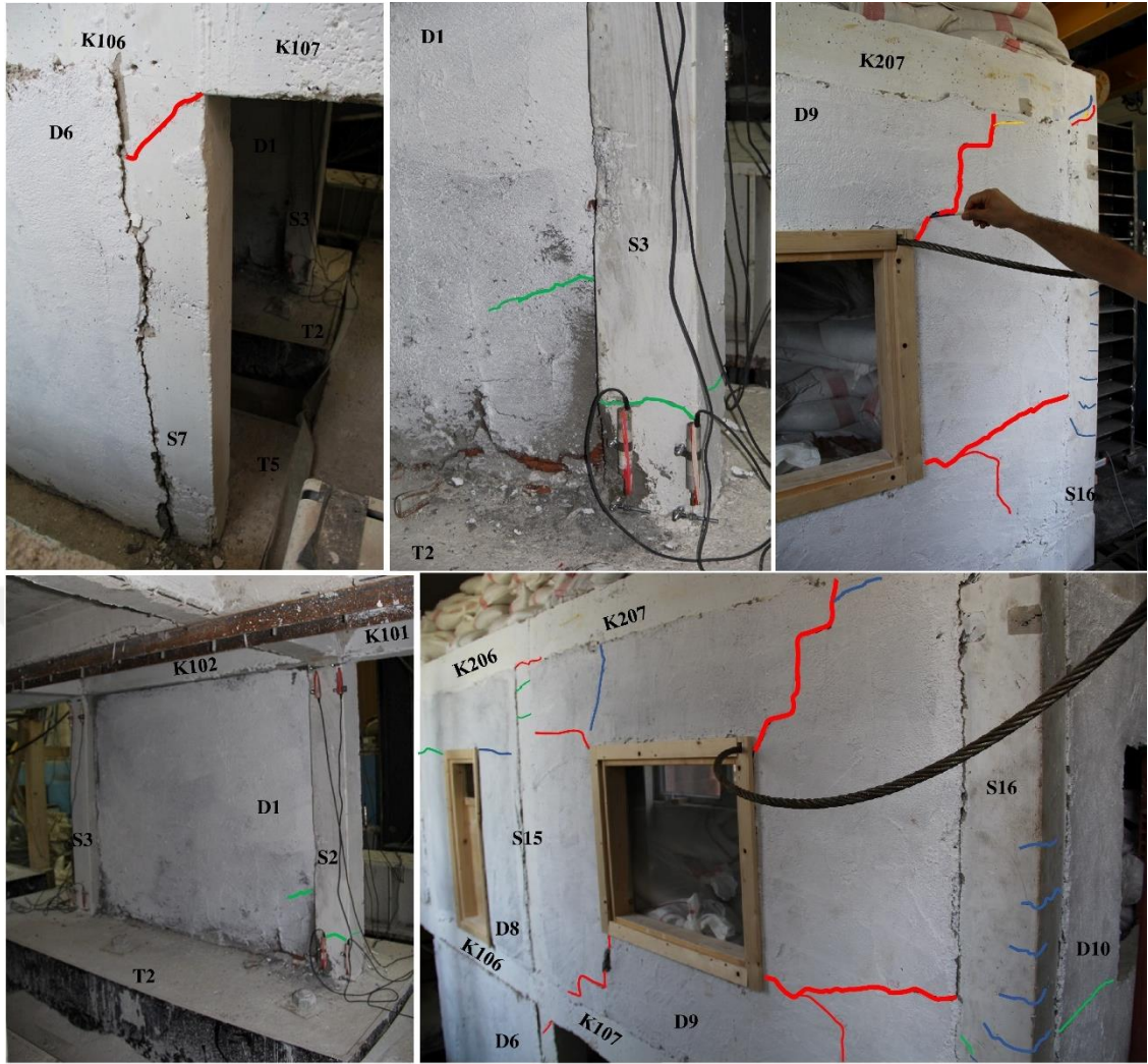
Şekil 4.5. Deney sırasında (%1.5 GKÖÖ'da) RDE'de gözlenen hasarlar
