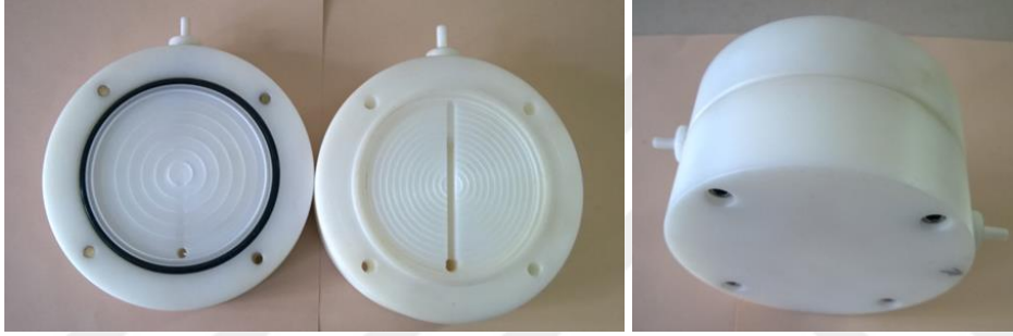
Şekil 3.6. Filtrenin yerleştirildiği teflon düzeneğin iç ve dış yapısı
