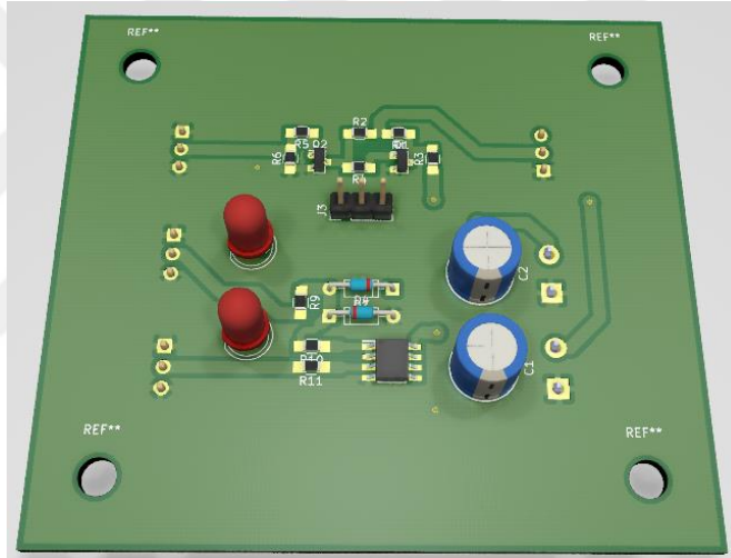
Servo motor kontrol modülünün tasarımının 3 boyutlu görüntüsü
