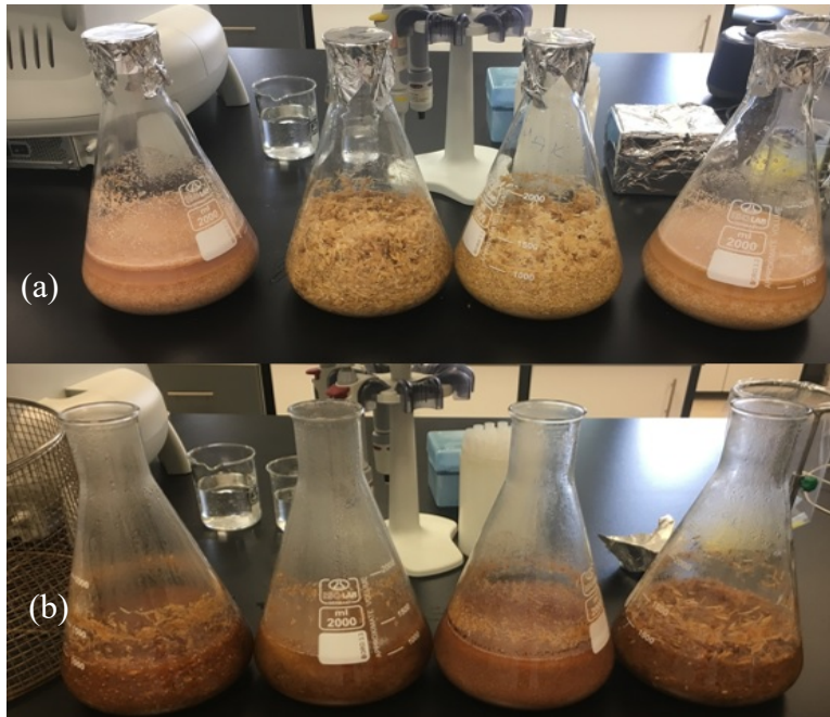
Şekil 3.4. Sülfürik asit eklenmiş lignoselülozik hammaddeler (a) Sülfürik asit ile muamele edilmiş lignoselülozik hammaddelerin otoklav öncesi görüntüsü (b) Sülfürik asit ile muamele edilmiş lignoselülozik hammaddelerin otoklav sonrası görüntüsü
