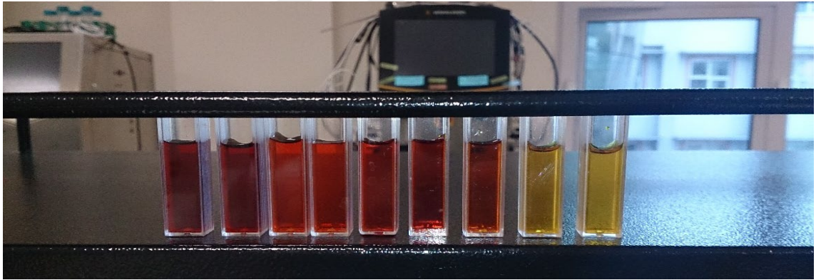
Şekil 3.6. İndirgen şeker analizi yapılan ve spektrofotometrede absorbansları ölçülen örnekler
