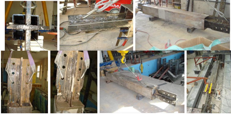
Şekil 3.31. Lama profilli BEÇÇ eleman yapım detayları
