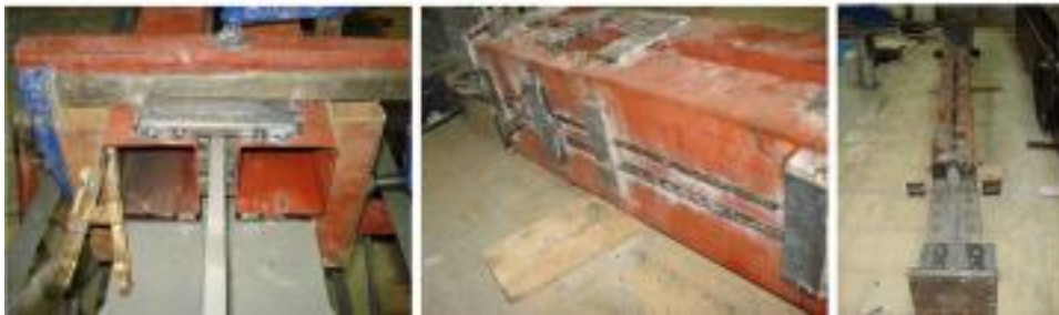
Şekil 3.27. Eleman 2. BEÇÇ_2 için yapım detayı
