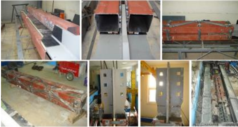
Şekil 3.29. Eleman 3. BEÇÇ_2 için yapım detayı
